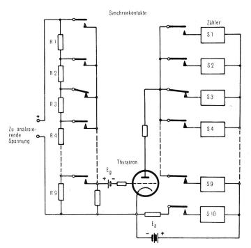
Fig. 5. Prinzip des schwedischen Signal-Analysers
