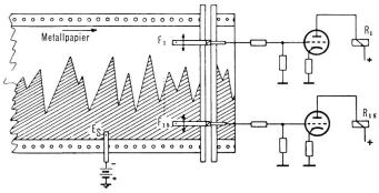
Fig. 2. Automatischer Abtaster zur Ermittlung der Wahrscheinlichkeitsverteilung
