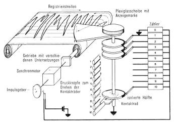
Fig. 1. Kurvenabtastgerät
