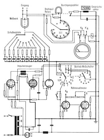
Fig. 3. Schaltbild des Häufigkeitszählers mit Kondensatoraufladung
