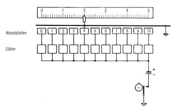
Fig. 4. Häufigkeitszähler mit registrierendem Kompensator
