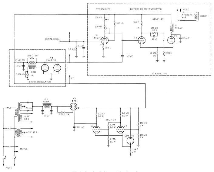
Fig. 6. Amerikanischer totalizing Recorder
