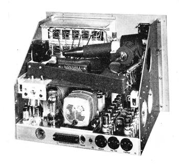
Fig. 11. Pegelanalysator von hinten
