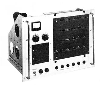
Fig. 12. Frontansicht des Pegelanalysators
