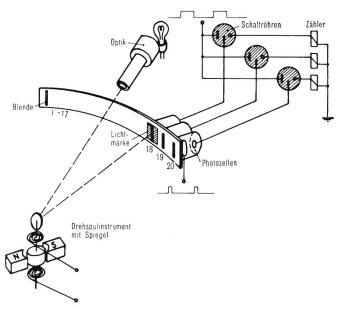
Fig. 8. Prinzip des Pegelanalysators
