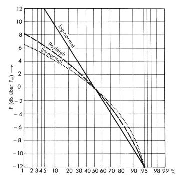
Fig. 8. Darstellung der Rayleigh-, der log-normalen und der linear-normalen Verteilung in einem log-normalen Verteilungsnetz. Die Parameter sind so gewählt, dass sowohl Median- als auch 95%-Werte übereinstimmen
