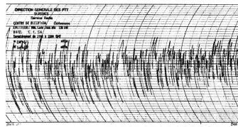
Fig. 5. Beispiele von Raumwellenregistrierungen des Senders Monte Carlo 1466 kHz in der Empfangsstation Châtonnave
