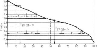
Fig. 6. Ermittlung der prozentualen Verteilungskurve der Momentanfeldstärke aus einer Raumwellenregistrierung
