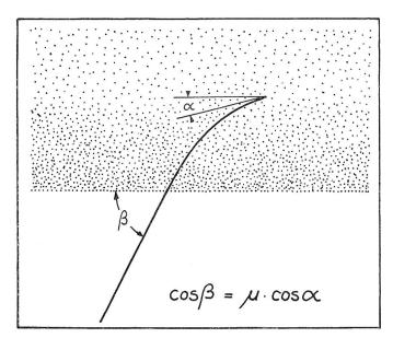
Fig. 2. Bahnverlauf einer elektromagnetischen Welle in der Ionosphäre
