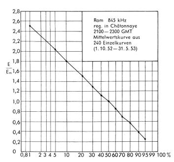
Fig. 12. Mittlere Verteilung der Momentanfeldstärke von zweistündigen Raumwellenregistrierungen (2100–2300 GMT) der Übertragungsstrecke Rom 845 kHz-Châtonnaye. Darstellung im Rayleigh-Netz
