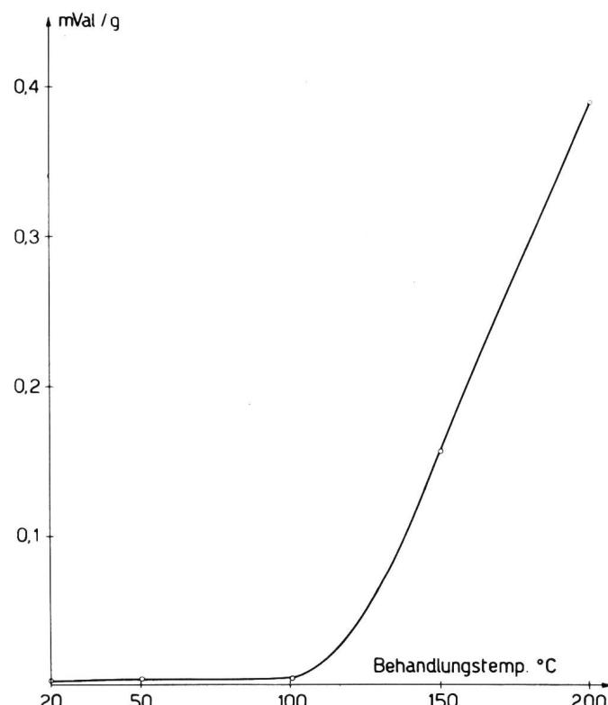
Fig. 3. Säuregehalt des wässrigen Auszuges in mVal/g von Rohjute, die bei verschiedenen Temperaturen gelagert wurde (Versuch im geschlossenen Gefäß). 1 mVal/g würde z. B. einem Essigsäuregehalt von 60 mg Säure (100%) pro Gramm Jute entsprechen
