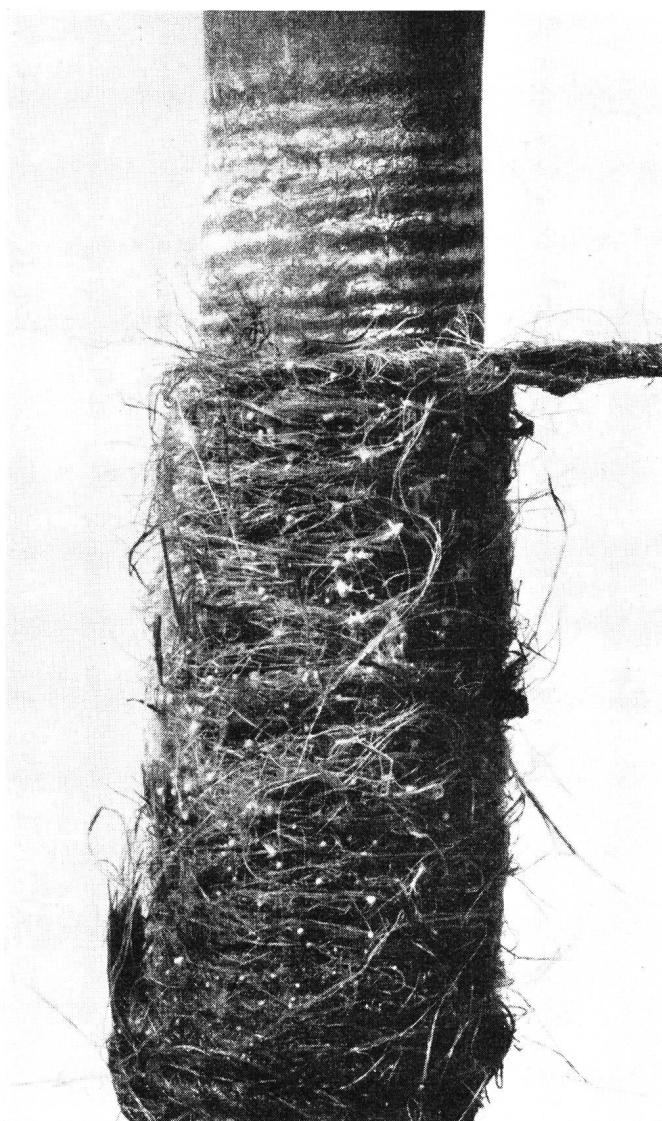
Fig. 4. Künstliche, durch Mikroorganismen erzeugte Korrosion auf einem Bleirohr. Es ist deutlich zu beobachten, dass auf der Oberfläche der aufgewickelten Jute Mikroorganismen wachsen. Am Bleirohr sind die unter der Jutekordel entstandenen Korrosionsangriffe zu erkennen
