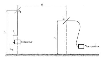
Fig. 1. Dispositif de mesure du rayonnement de récepteurs
