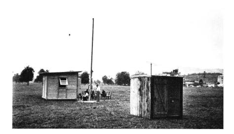
Fig. 3. Mesure à  $10~\mathrm{m}$  — méthode 12-1-S-18. (Le dipôle situé sur la cabine antérieure ne devrait pas être replié mais simple)
