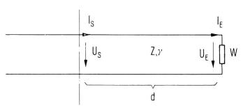
Fig. 4. Spannungen und Ströme auf einer Leitung
