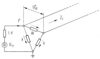
Fig. 10. Kompensation der Störspannung durch eine unsymmetrische Ableitung  $\mathbf{Y}$
