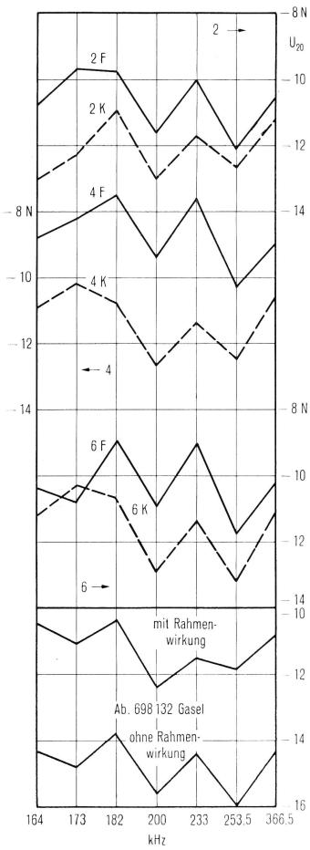
Fig. 16. Symmetrische Störpegel  $U_{20}$  auf den Schlaufen 2, 4, 6 mit Aufstiegskabeln Typ F mit Bleimantel (F) und mit ungeschirmten Kunststoff-Aufstiegskabeln (K)
