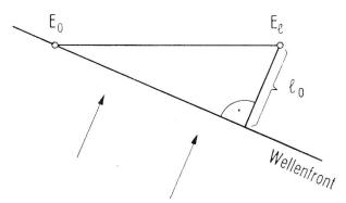
Fig. 7. Die in den Aufstiegen induzierten elektromotorischen Kräfte  $E_0$  und  $E_l$  unterscheiden sich in Betrag und Phase in Abhängigkeit von der Wegdifferenz  $l_0$
