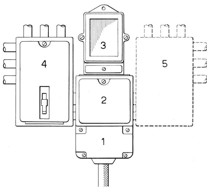
Fig. 2. Kombination eines Hausanschlusskastens mit Zähler und Verteilung
