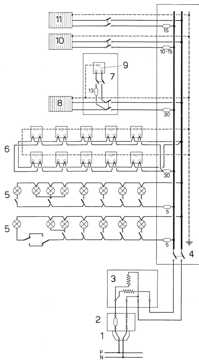
Fig. 1. Schema einer Hausinstallation
