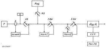
Fig. 1. Konventionelle Wahlstufengestaltung T rufender Teilnehmer; A Anruforgan; Z Gesprächszähler; AS Anrufsucher; GW Gruppenwähler; RS Registersucher; Reg. Register; Mark Markierstromkreis; Abg. VL Relaissatz der abgehenden Leitung; ZZZ Zeitzonenzähler;  $Tax\ JG$  Taximpulsgeber; Vorwahl Steuerstromkreise für die Anrufsucher
