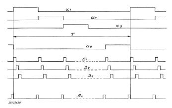
Fig. 3. Impulsprogramm für 100 zeitliche Identifikationen (Impulse verschiedener Dauer) α 1...10 Zehnerzeitmarken; β 1...10 Einerzeitmarken; T eine Periode, innerhalb welcher 100 α/β-Koinzidenzfälle möglich sind
