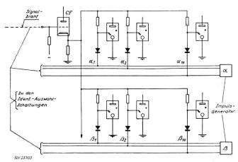
Fig. 7. Empfangsseitiges Auswerten einer Impulsidentifikation CF Kathodenfolgestufe
