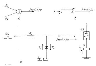
Fig. 5. Erfassen einer zeitlichen Identifikation  $\alpha_X$ ,  $\beta_U$  Zeitmarkenimpulse gemäss Figuren 3 und 4 für Identifikation Nr. xy; a allgemeine Darstellung eines «Impulstors» für zwei Koinzidenzelemente; b Erfassen der Koinzidenz mit Relais; c «Impulstor»-Schaltung;  $R_0$  Ohmscher Widerstand;  $R_D$  Durchlasswiderstand des Gleichrichters;  $R_S$  Sperrwiderstand des Gleichrichters; GR Glimmrelais (Kaltkathoden-Triggerröhre); M Relais oder Schaltmagnet
