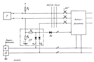
Fig. 6. Vorwahl mittels Impulsidentifikation T rufender Teilnehmer;  $R_A$ ,  $R_B$  Ohmsche Widerstände (Linienstromkreis); IT Impulstor des Teilnehmers T; Sp Entkopplungsgleichrichter; AS Anrufdurchschalter
