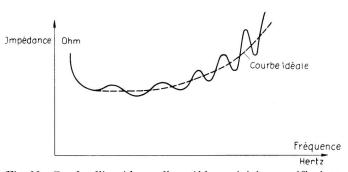
Fig. 11. Courbe d'impédance d'un câble pupinisé avec réflexions
