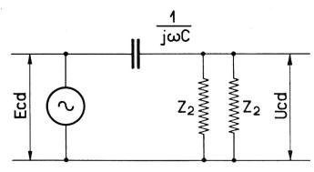
Fig. 2. Relation entre la force électromotrice induite Ecd et la tension perturbatrice Ucd
