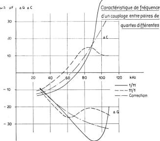
Fig. 31. Caractéristiques de fréquence typiques de couplages dans un ancien câble à quartes  $\rm DM$
