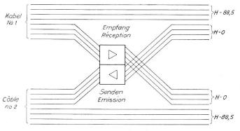
Fig. 13. Changement des sens de conversation pour l'équilibrage des différences de niveaux
