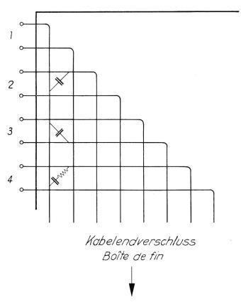
Fig. 28a. Montage du réseau d'équilibrage
