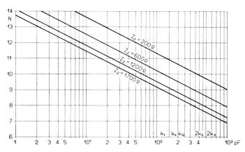
Fig. 4. Relation entre couplage capacitif et affaiblissement diaphonique à  $800~{
