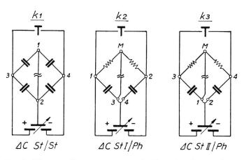
Fig. 5. Montages de mesure servant à déterminer les couplages capacitifs
