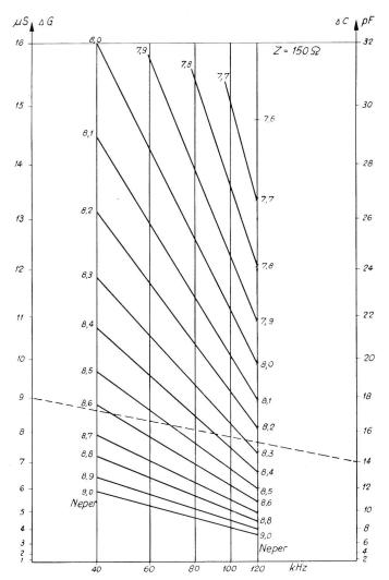
Fig. 25. Graphique établi pour déterminer l'affaiblissement diaphonique d'après les fractions de couplage  $\triangle$  G et  $\triangle$  C
