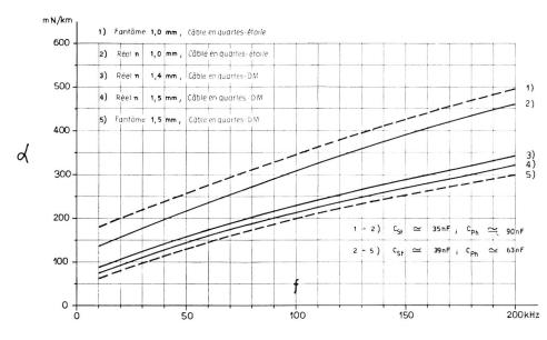
Fig. 17. Coefficient d'affaiblissement caractéristique de câble à quartes-étoile et DM
