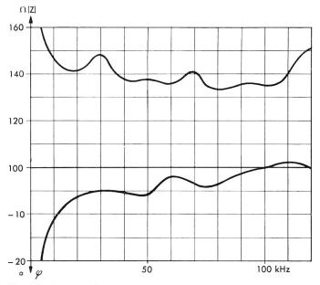
Fig. 33. Courbe d'impédance d'un ancien câble à quartes DM
