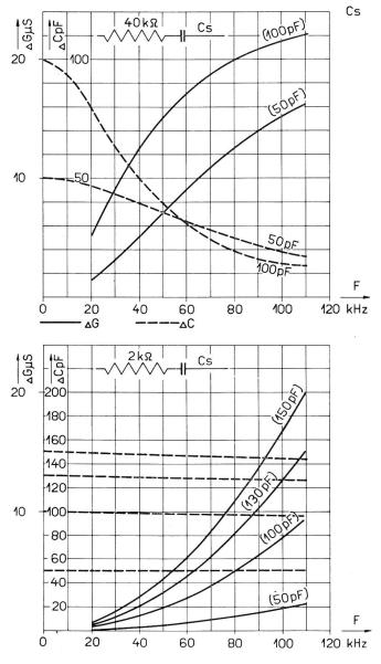
Fig. 30. Caractéristiques de fréquence d'éléments RC
