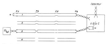
Fig. 16. Mesure du couplage télédia phonique  $\frac{1}{3}$
