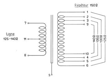
Fig. 32. Schéma d'une bobine translatrice de ligne
