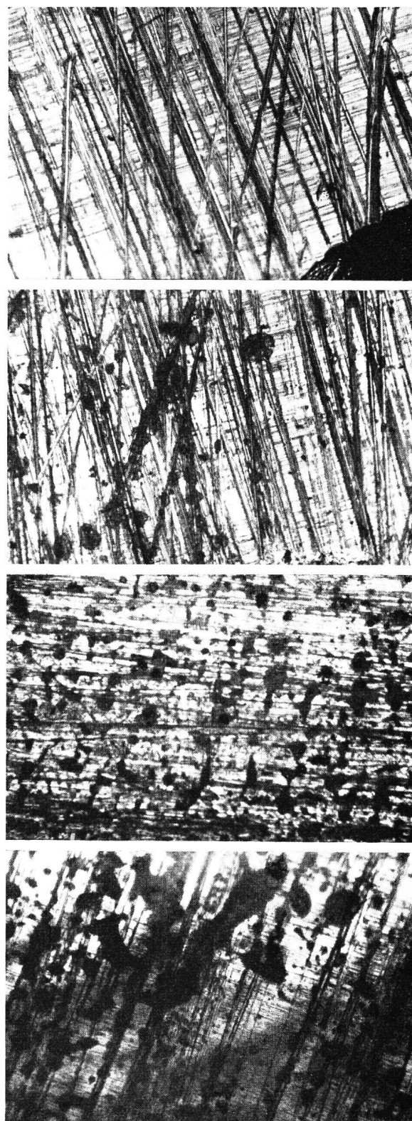
Fig. 6. Corrosion dépendant de la quantité de chlorhydrate d'aniline contenue dans la colophane (grossissement: 75 fois)
