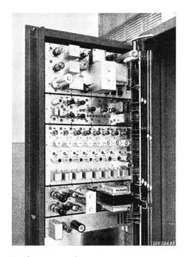
Fig. 14. Empfangsstation für 8 Messwerte der rapidzyklischen Fernmessübertragung
