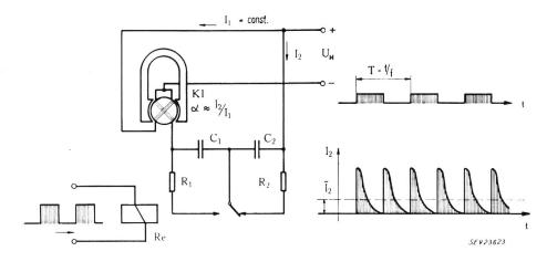
$\begin{array}{c} \text{Fig. 4.} \\ \text{Fernmessempfänger nach dem Kondensatorumladeverfahren} \\ Re \text{ Empfangsrelais; } R_1, R_2 \text{ Ladewiderstände; } C_1, C_2 \text{ Ladekondensatoren; } KI \text{ Kreuzspulinstrument; } I_1, I_2 \text{ Ströme; } a \text{ Ausschlag von } KI; U_H \text{ Hilfsspannung; } f \text{ Impulsfrequenz; } T \text{ Impulsperiode; } \overline{I_2} \text{ Mittelwert des Stromes } I_2 \end{array}$
