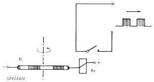
Fig. 1. Fernmessgeber mit rotierendem Schalter K kollektorähnlicher Schalter; Re Senderelais
