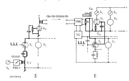
Fig. 12. Rapidzyklische Mehrfach-Fernmessübertragung
