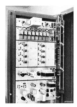
Fig. 13. Sendestation für 8 Messwerte der rapidzyklischen Fernmessübertragung
