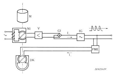
Fig. 8. Fernmessgeber mit Kompensator und Impulsumsetzer M Meßsystem der fernzumessenden Grösse; NI Nullindikator; DK Drehspul-Kompensationsinstrument; V Verstärker; Gl Gleichrichter; IG Impulsgeber; FME Fernmessempfänger; I messwertproportionaler Gleichstrom
