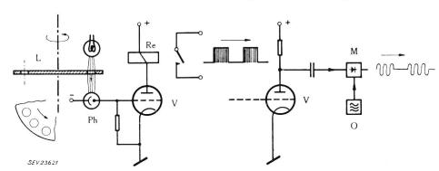
Fig. 2. Fernmessgeber mit Lichtstrahltastung L Lochscheibe; Ph Photozelle; V Verstärker; Re Senderelais; M Modulator; O Oszillator
