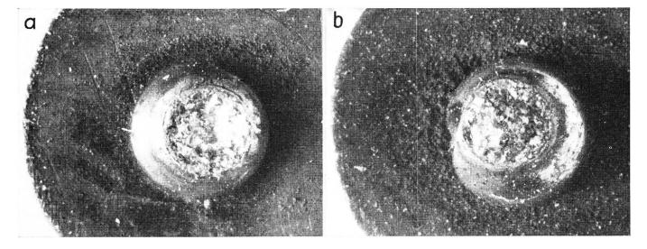
Fig. 5. Contacts à forte teneur en or chargés électriquement, après  $10^7\,\mathrm{connexions}$
