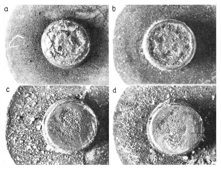
Fig. 8. Contacts en tungstène chargés électriquement après 107 connexions
