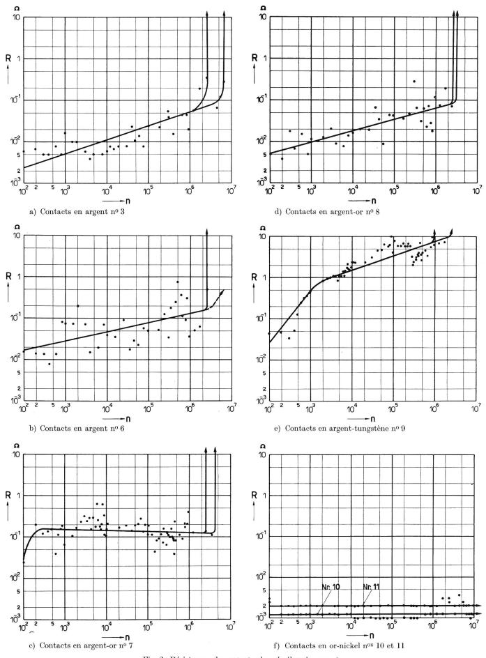
Fig. 2. Résistances de contacts chargés électriquement
