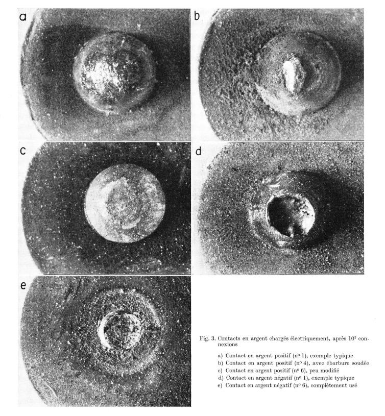
2.4. Essais microscopiques sur des contacts chargés électriquement
