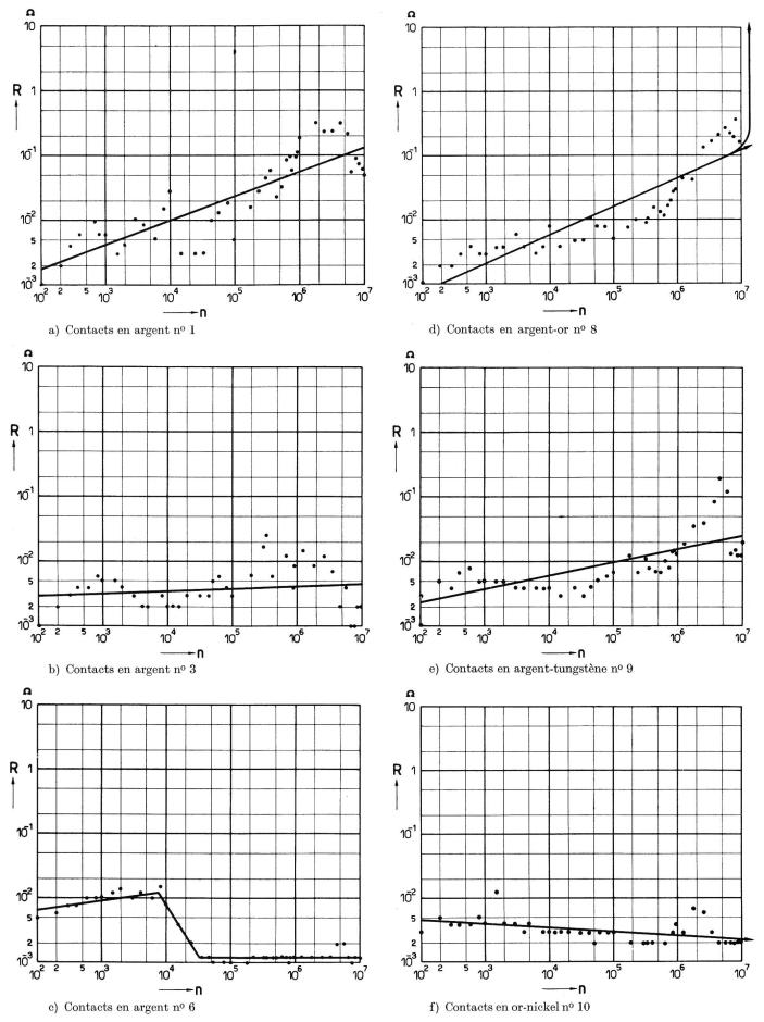
Fig. 9. Résistances de contacts connectés sans courant
