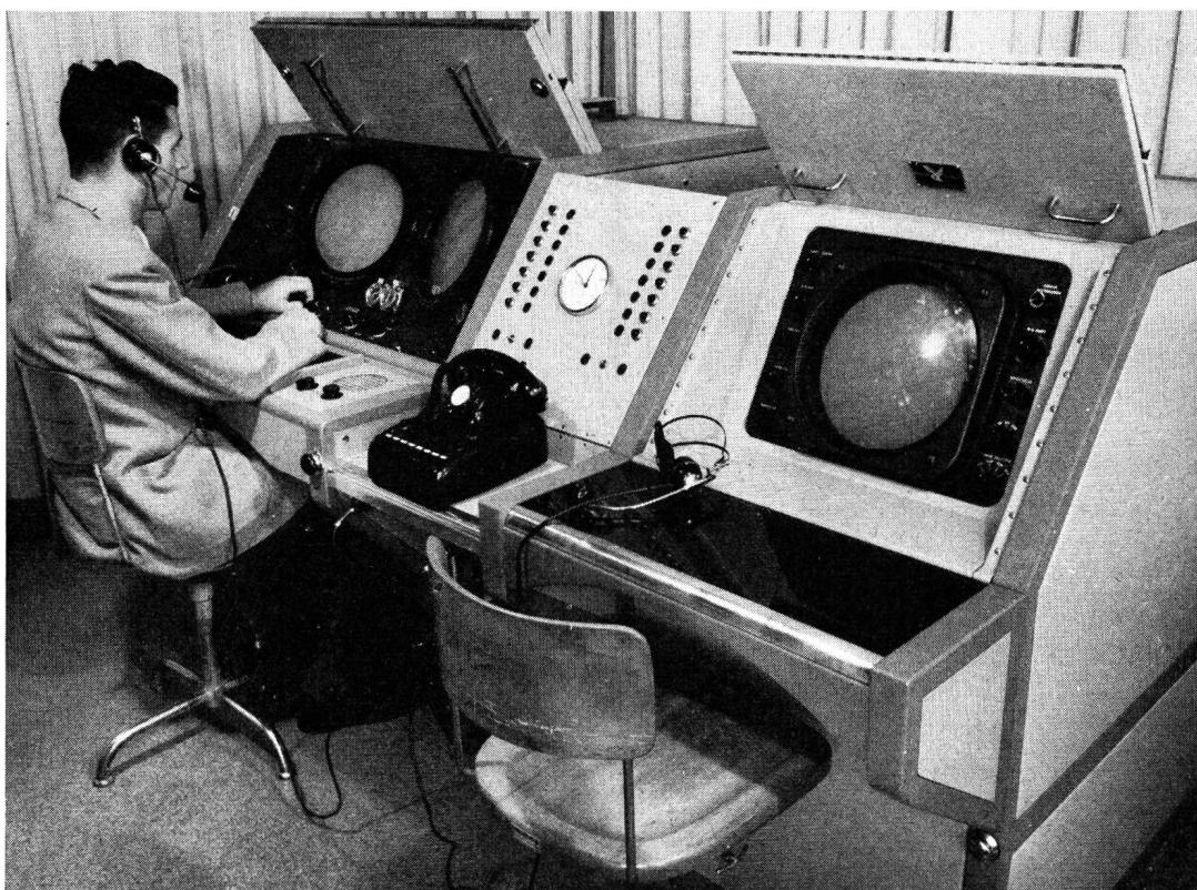
Fig. 8. Radar-Arbeitspulte für den Schlechtwetteranflug. Rechts der Anzeigeschirm des Überwachungsradars, links Azimut- und Elevationsanzeigeschirm des Präzisions-Landerradars. In der Mitte Wellenwähler für die Sprechverbindungen mit den Flugzeugen
