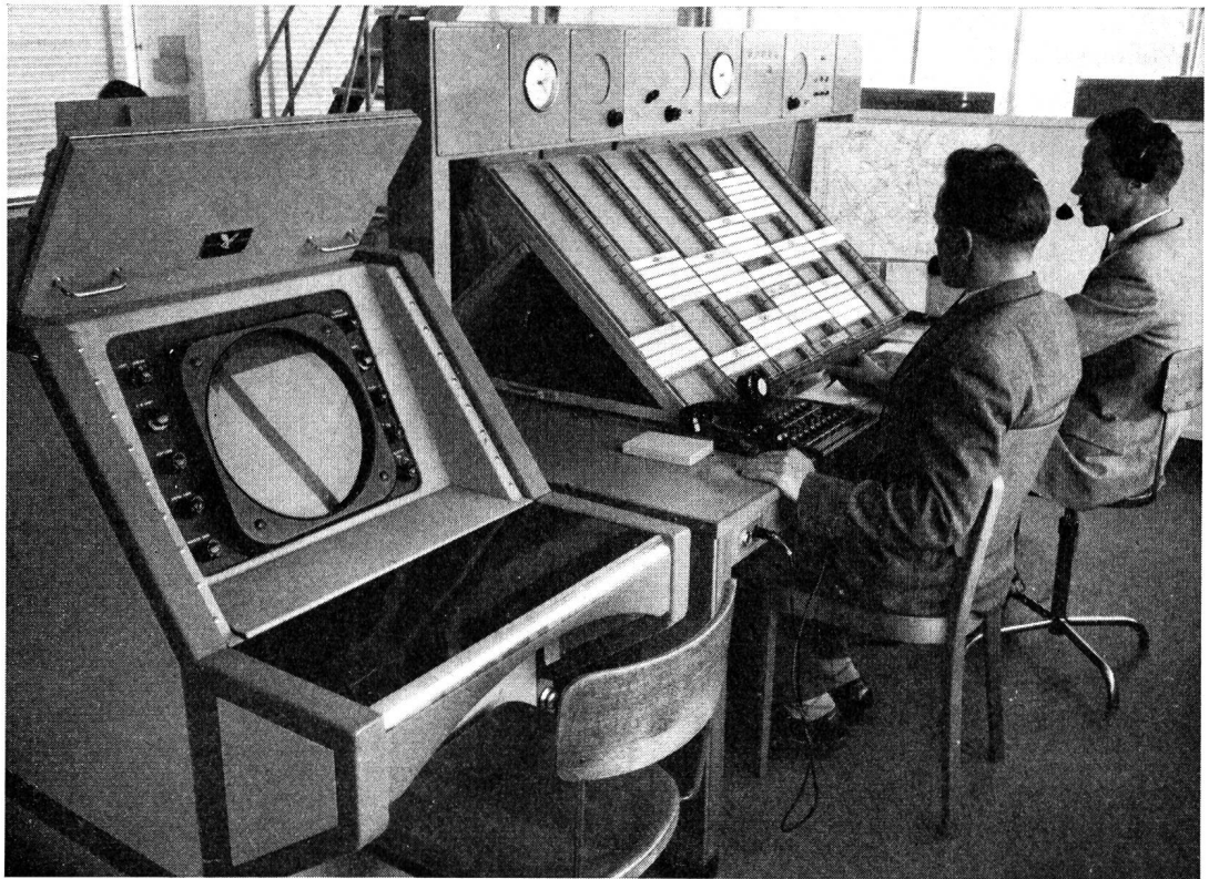
Fig. 15. Arbeitsplatz der Luftstrassenkontrolle. Links Anzeigenschirm des Überwachungsradars Poste de travail du contrôle des routes aériennes. A gauche, écran du radar de surveillance
