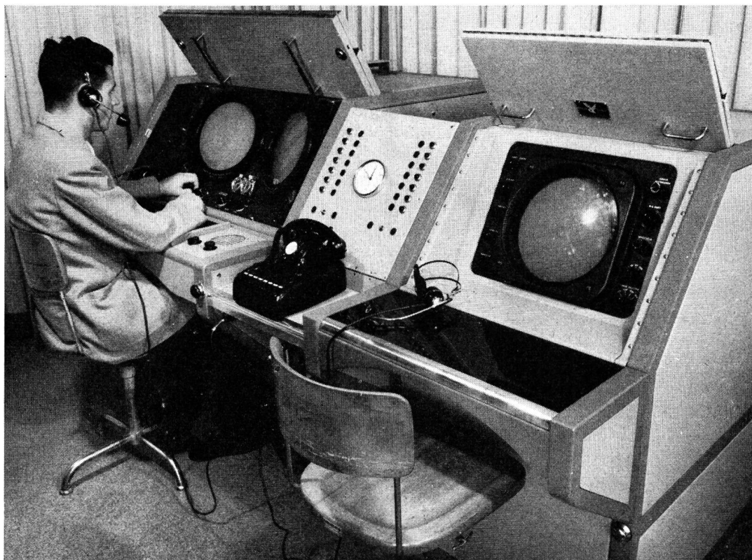
Fig. 8. Radar-Arbeitspulte für den Schlechtwetteranflug. Rechts der Anzeigeschirm des Überwachungsradars, links Azimut- und Elevationsanzeigeschirm des Präzisions-Landeradars. In der Mitte Wellenwähler für die Sprechverbindungen mit den Flugzeugen
