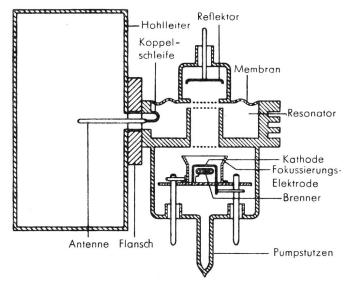
Fig. 33. Schema eines Reflexionsklystrons (gleichzeitig Aufbau der Telefunken-Röhre TK 7)
