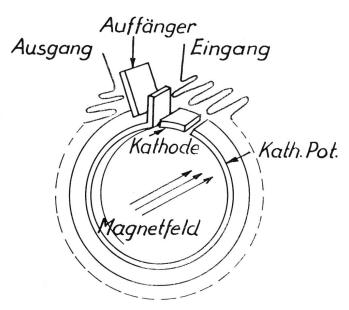
Fig. 28. Wanderfeld-Magnetron-Verstärkerröhre mit kreisförmiger Flachwendel als Verzögerungsleiter
