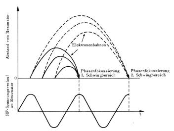
Fig. 34. Veranschaulichung des Vorganges der Phasenfokussierung beim Reflexionsklystron
