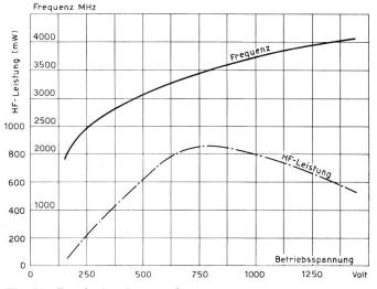
Fig. 22. Durchstimmkurven des Karzinotrons CO 127 der CSF Paris
