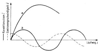
Fig. 7. Amplitude des Elektronenwechselstromes eines geschwindigkeitsgesteuerten Elektronenstrahls im Laufraum eines Klystrons
