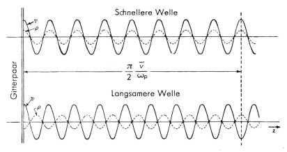
Fig. 8. Raumladungswellen in einem Elektronenstrahl infolge Geschwindigkeitssteuerung durch ein Gitterpaar, an dem eine HF-Spannung liegt. Die beiden Wellen pflanzen sich in z-Richtung fort mit Geschwindigkeiten grösser und kleiner als die mittlere Elektronengeschwindigkeit  $\overline{\mathbf{v}}$ .  $\mathbf{v} = \mathbf{Geschwindigkeits}$ ,  $\varrho = \mathbf{Dichtewelle}$  der Elektronen
