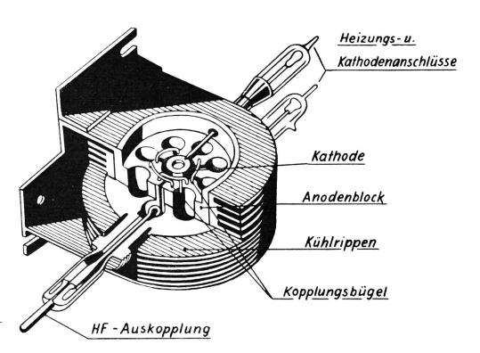
Fig. 29. Schnittzeichnung einer Magnetron-Senderöhre für Zentimeterwellen
