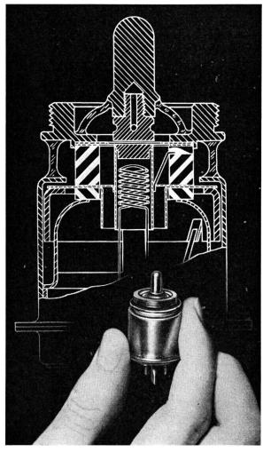
Fig. 4. Mikrowellentriode 416 A der Western Electric
