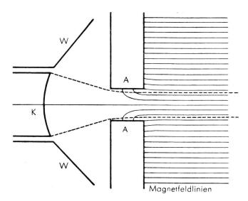
Fig. 19. Grundsätzlicher Aufbau einer Elektronenkanone (Pierce-Kathode)
