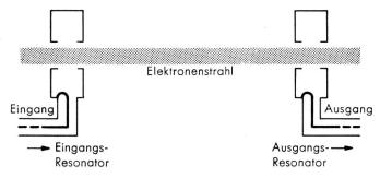
Fig. 5. Prinzip eines Zweikreisklystrons
