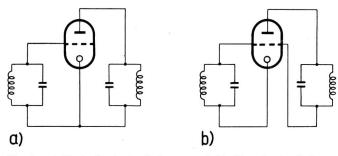
Fig. 1. a) Kathodenbasisschaltung und b) Gitterbasisschaltung einer Triode
