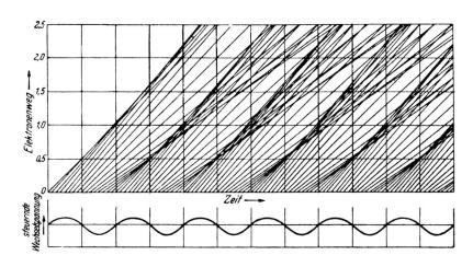
Weg-Zeit-Diagramm (Elektronenfahrplan) eines geschwindigkeitsgesteuerten Elektronenstrahles
