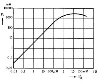
Fig. 17a. Abhängigkeit der HF-Ausgangsleistung  $P_a$  von der HF Eingangsleistung  $P_e$  für die TL 6
