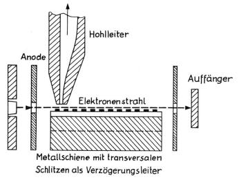
Fig. 24. Schema eines Karzinotrons für Millimeterwellen
