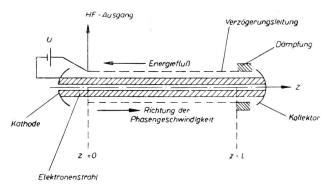
Fig. 21. Schema eines Karzinotrons
