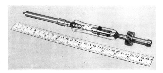
Fig. 38. Strophotron der Firma Svenska Elektronrör, Stockholm
