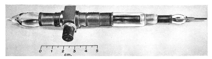
Fig. 32. b) Gesamtansicht der Röhre ohne Magnet
