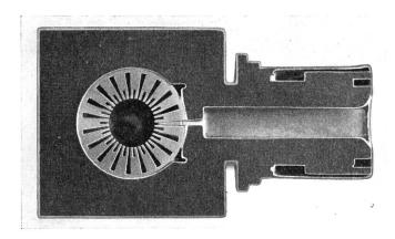
Fig. 32. Rising-Sun-Magnetron für  $\lambda=6.3\,\mathrm{mm}$  (Columbia Radiation Laboratory, New York).
