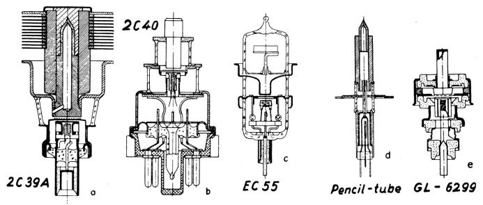
Fig. 3. Schnittzeichnungen einiger gebräuchlicher Scheibentrioden
