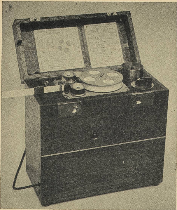
Apparat zur Kontrolle der Gesprächstaxierung
