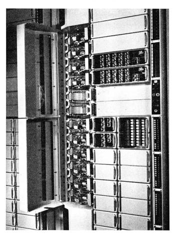
Fig. 3. Teilnehmergestell mit Teilnehmerschaltungen, Anrufsucher und Leitungswähler. Die Verschalung der Wähler und Relaissätze zum Teil geöffnet
