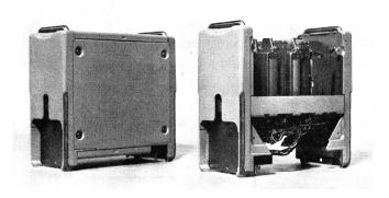
Fig. 5. Steckbarer Relaissatz, rechts mit entfernten Schutzblechen Jeu de relais à prises à fiches, à droite avec tôles de protection enlevées
