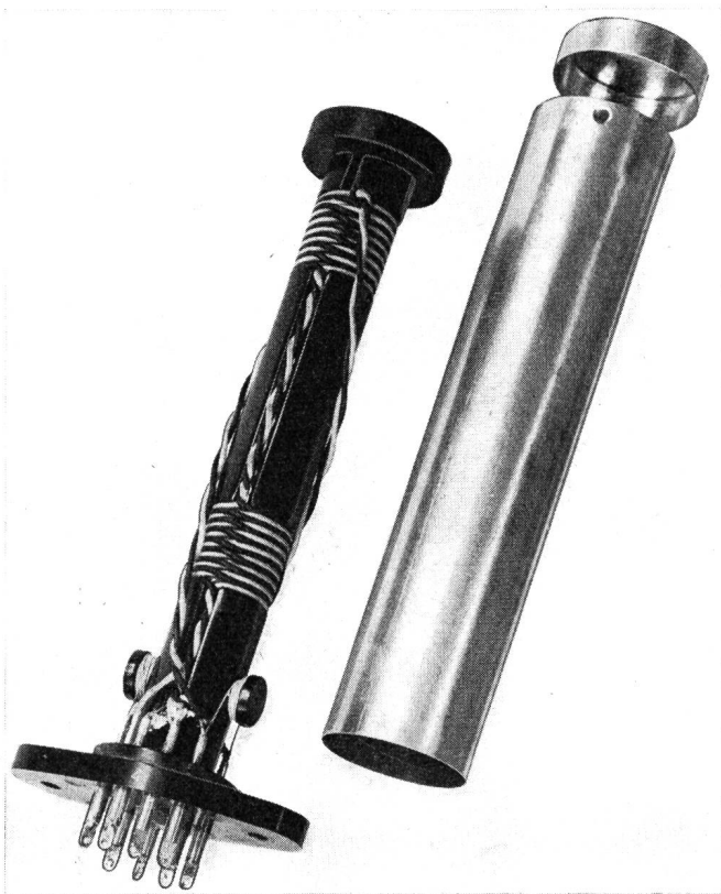
Fig. 26b. Ausführung des magnetischen Entkopplungsgliedes
