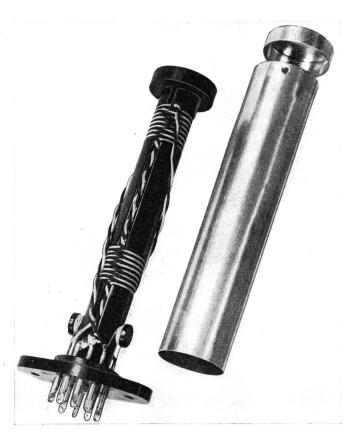
Fig. 26b. Ausführung des magnetischen Entkopplungsgliedes
