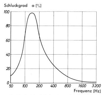
Fig. 10b. Typische Schluckgradkurve eines Resonators
