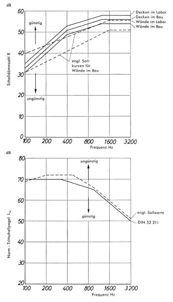
Fig. 8. oben = Sollkurven für Schalldämmzahlen unten = Sollkurve für den Norm-Trittschallpegel
