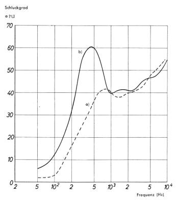
Fig. 9. Schluckgrad einer 2 cm dicken Glasfaserplatte (Hall-raum-Messung)
