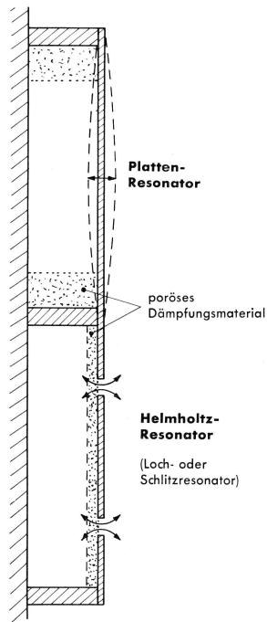
Fig. 10a Mitschwingende Absorber
