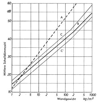
Fig. 3. Mittlere Schalldämmzahl von Wänden in Abhängigkeit vom Wandgewicht
