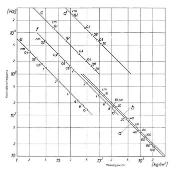
Fig. 6. Koinzidenzfrequenz in Abhängigkeit vom Wandgewicht für verschiedene Materialien:
