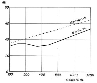
Fig. 4. Koinzidenzeffekt an einer Einfachwand von 100 kg/m² Flächengewicht (Bimsbeton, beiderseits verputzt)
