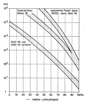
Fig. 2. Isolationswiderstände von Sicherungsserien  $20\times 2$  mit verschiedenen Hartpapierisolationen. Messung: alle a  $\longrightarrow$  alle b+E
