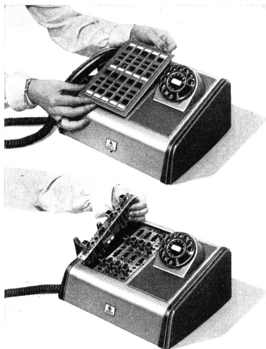
Fig. 2. Die leichte Zugänglichkeit zu allen Teilen der Albis-Telephonstation
