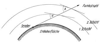
Fig. 5. Demonstration, dass die Möglichkeit der Superrefraktion mit der Höhe der Umkehrschicht abnimmt. Winkel b ist grösser als Winkel a
