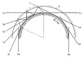
Fig. 10 a. Verlauf der Sonnenstrahlen um die Erde herum. R= Empfänger; F= Parasitenherd; I= Ionosphäre in der Höhe von 100 km
