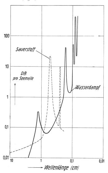
Fig. 8. Dämpfung von Mikrowellen durch atmosphärische Gase
