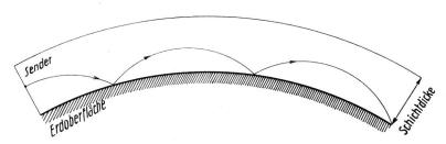
Fig. 4. Wellenführung durch Superrefraktionsschicht
