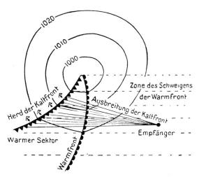
Fig. 15. Die Verteilung der Parasiten in einer Zyklone, in der Zone des Schweigens und in der aktiven Zone
