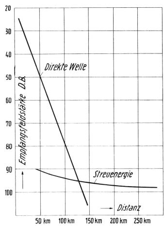
Fig. 6. Reichweite-Vergrösserung durch Streuung an turbulenten Luftkörpern
