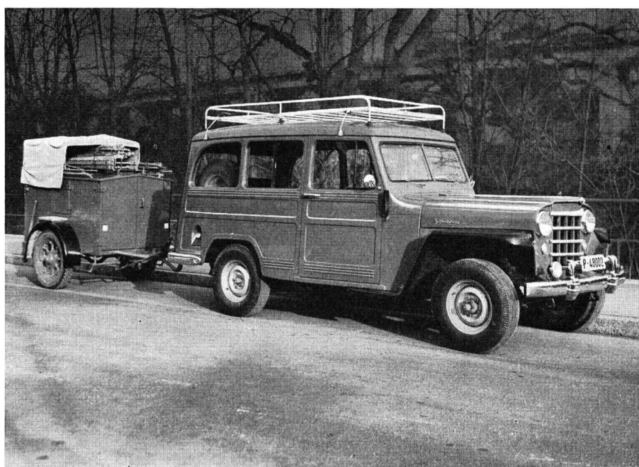
Fig. 9. Stations-Wagen mit Werkzeugan- hänger für eine Spleissergruppe. Der Wagen hat Vierradantrieb und ist geländegängig. Er kann für Personen- oder für Materialtransporte eingesetzt werden
