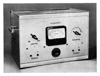
Fig. 5. Breitband-Gegentaktverstärker für 200 Watt Ausgangsleistung (Frequenzbereich 10–300 kHz)
