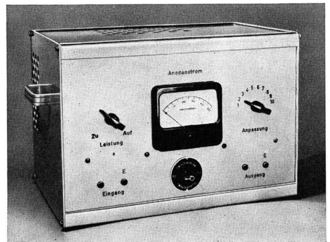
Fig. 5. Breitband-Gegentaktverstärker für 200 Watt Ausgangsleistung (Frequenzbereich 10–300 kHz)
