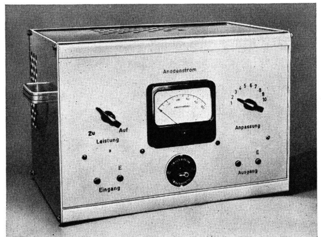
Fig. 5. Breitband-Gegentaktverstärker für 200 Watt Ausgangsleistung (Frequenzbereich 10-300 kHz)
