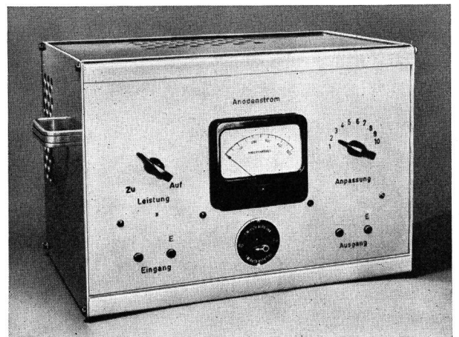
Fig. 5. Breitband-Gegentaktverstärker für 200 Watt Ausgangsleistung (Frequenzbereich 10-300 kHz)
