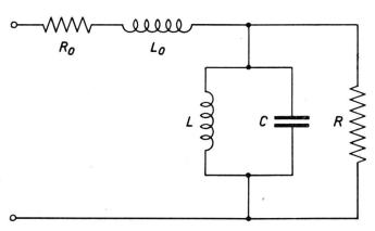
Fig. 2. Ersatzschema des magnetostriktiven Wandlers (Ausführung e in Fig. 1)
