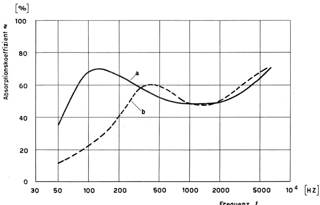
Fig. 8. Vergleich der Schallabsorption einer weichen Pavatexplatte in gewöhnlicher Befestigung und als Plattenresonator
