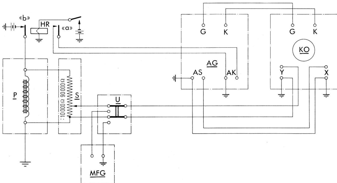
Fig. 1. Schaltungsanordnung zur Messung der EMK der Selbstinduktion
