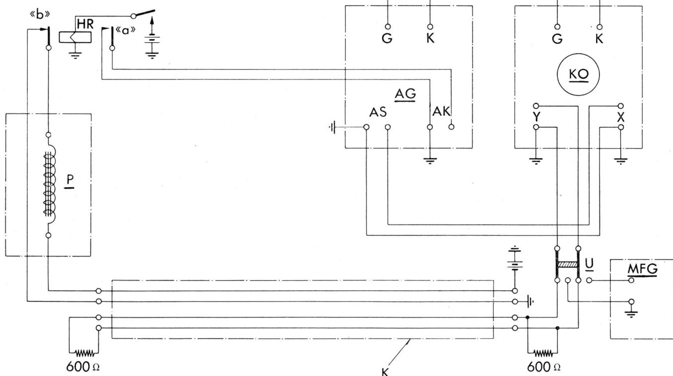
Fig. 2. Schaltungsanordnung zur Messung der induzierten Spannung in einem benachbarten Adernpaar
