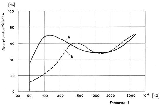
Fig. 8. Vergleich der Schallabsorption einer weichen Pavatexplatte in gewöhnlicher Befestigung und als Plattenresonator Kurve a: Schallabsorption mit Plattenresonatoren. Ein Mittelwert aus drei praktischen Anwendungen in Studioräumen (nach Sabine berechnet) Kurve b: Schallabsorption einer 24 mm dicken gelochten Pavatex-Akustikplatte, die direkt an die Wand geklebt ist (nach Millington berechnet)
