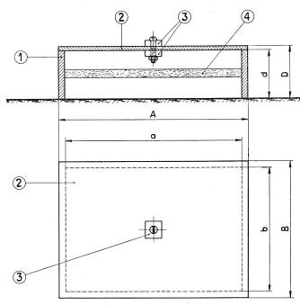
Fig. 1. Skizze eines Plattenresonators
