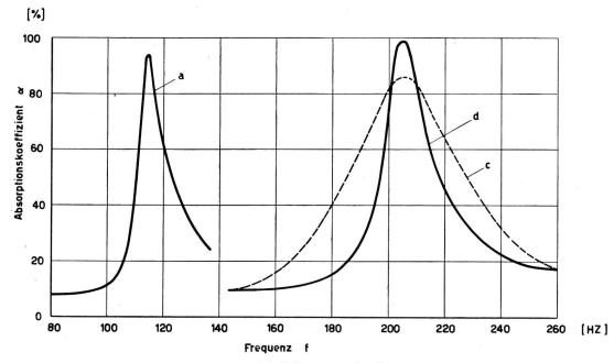
Fig. 5. Im Rohr gemessene Schallabsorption des Plattenresonators Typ C 2
