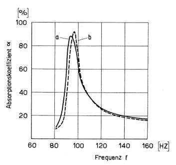
Fig. 3. Im Rohr gemessene Schallabsorption des Plattenresonators Typ B. Kurve a: Mit Zusatzgewicht, mit Dämpfung
