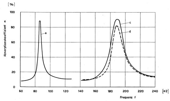
Fig. 4. Im Rohr gemessene Schallabsorption des Plattenresonators Typ C 1.
