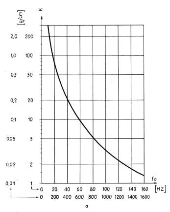
Fig. 2a+b. Diagramm zur Bestimmung der Resonanzfrequenz eines Plattenresonators aus seinen charakteristischen Grössen
