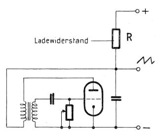
Fig. 25. Sperrschwinger zur periodischen Entladung eines Kondensators
