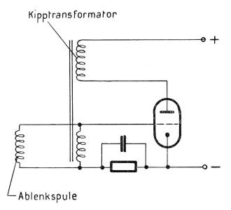
Fig. 27. Transformator-Kippschaltung
