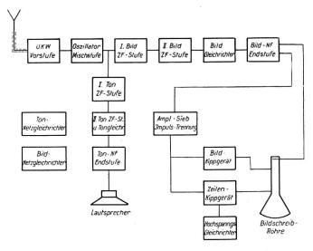
Fig. 18. Fernsehempfänger, Aufbauschema
