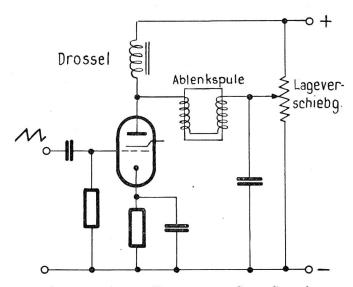
Fig. 26. Verstärker zur Erzeugung von Strom-Sägezähnen
