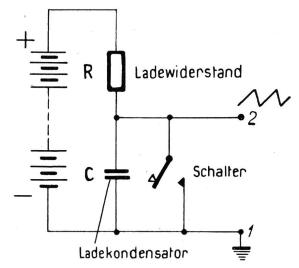
Fig. 21. Anordnung zur Erzeugung von Spannungs-Sägezähnen, schematisch
