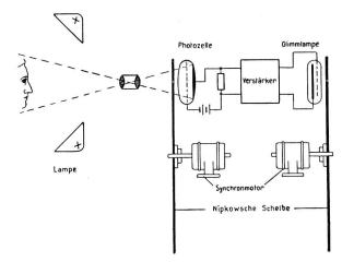
Fig. 2. Fernsehübertragung, schematisch. Bildfeldzerlegung im Sender und im Empfänger durch eine Nipkowscheibe
