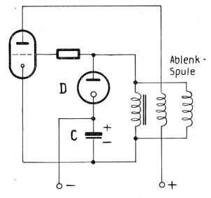
Fig. 28. Rückgewinnung der in der Zeilenspule gespeicherten Energie
