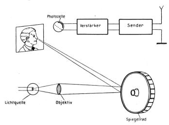
Fig. 3. Fernsehsender, Abtastung des Bildfeldes durch Spiegelrad
