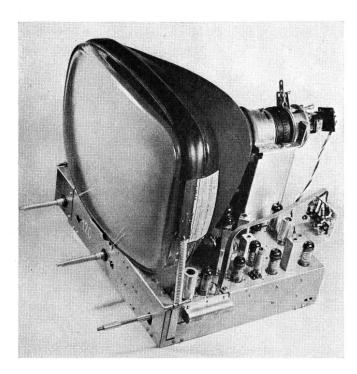
Fig. 19. Fernsehempfänger, Ansicht des Chassis
