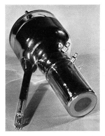
Fig. 14. Bildwandler-Ikonoskop, Ansicht einer Röhre
