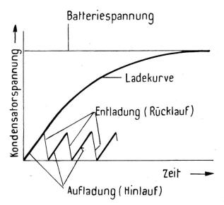
Fig. 22. Exponentieller Spannungsanstieg bei Aufladung eines Kondensators über einen Vorwiderstand
