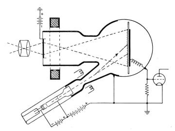
Fig. 13. Bildwandler-Ikonoskop, schematisch
