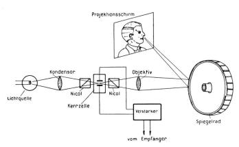
Fig. 4. Fernsehempfänger mit Spiegelrad und Kerrzelle
