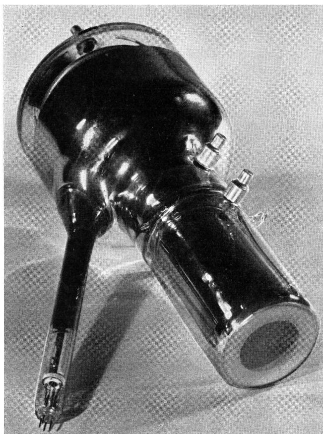
Fig. 14. Bildwandler-Ikonoskop, Ansicht einer Röhre
