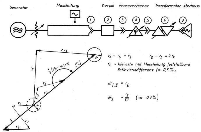
Fig. 5. Messmethode mit gedrehtem Kompensationsvektor
