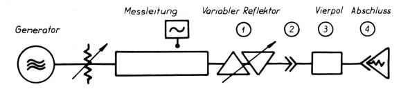
r<sub>E</sub> = kleinste , mit Messleitung feststellbare Reflexionsdifferenz
