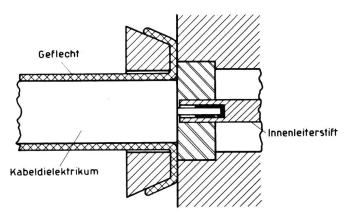
Fig. 20. Konstruktion der Übergangsstelle vom Kabel auf den Steckkontakt bei den Typen A, F, G und H
