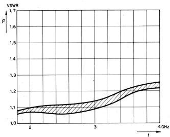
Fig. 28. Steckerpaar Typ J,  $Z_0=75\;\Omega$
