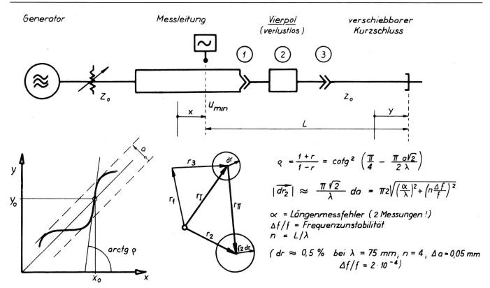
Fig. 1 Knotenverschiebungsmethode nach Weissfloch
