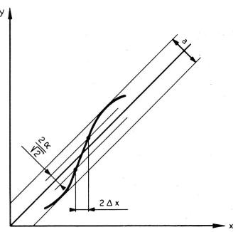
Fig. 4 Zur Berechnung des Phasenfehlers der Knotenverschiebungsmethode
