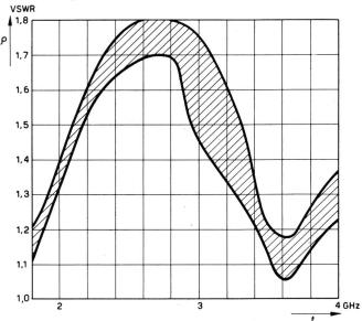
Fig. 14. Steckerpaar Typ D,  $Z_0=50\,\Omega,$  montiert nach Anleitung der Herstellerfirma
