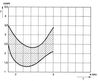
Fig. 34. Steckerpaar Typ P, nicht angepasst
