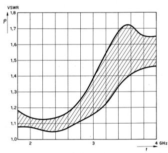
Fig. 13. Steckerpaar Typ C,  $\mathbf{Z}_0=50\,\Omega,$  montiert nach Anleitung der Herstellerfirma
