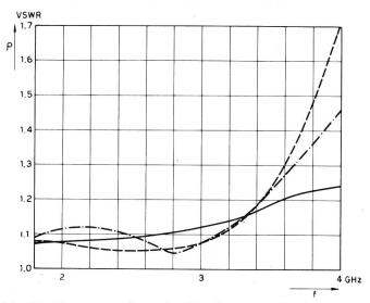
Fig. 35. Zusammenstellung der Mittelwerte aus den Messungen an den Steckern Typ $\,$  J, 75  $\Omega$  ———— K, 60  $\Omega$  — ————
