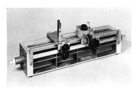
Fig. 7. Koaxiale Messleitung mit variablem Reflektor
