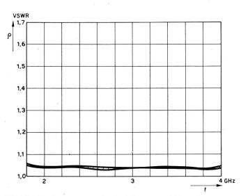
Fig. 10. Zwei zusammengehörige Messungen («Doppelmessung») am gleichen Steckerpaar
