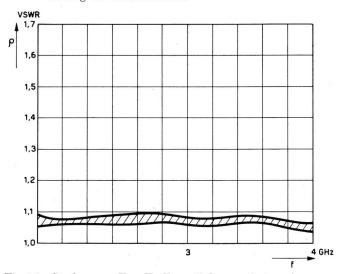
Fig. 15. Steckerpaar Typ E,  $Z_0=50\,\Omega,$  montiert auf starres Rohr, nach Anleitung der Herstellerfirma
