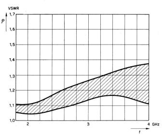
Fig. 11. Steckerpaar Typ A,  $Z_0=50\,\Omega,$  montiert nach Anleitung der Herstellerfirma
