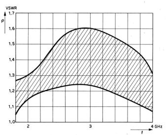
Fig. 12 Steckerpaar Typ B,  $\mathbf{Z}_0 = 50~\Omega,$  montiert nach Anleitung der Herstellerfirma
