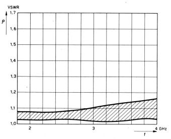
Fig. 16. Steckerpaar Typ F,  $Z_0=50\,\Omega$ , Weiterentwicklung von Typ A, montiert nach Angaben der Herstellerfirma
