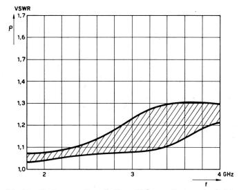
Fig. 17. Steckerpaar Typ G,  $Z_0=50\,\Omega,$  montiert nach Anleitung der Herstellerfirma.
