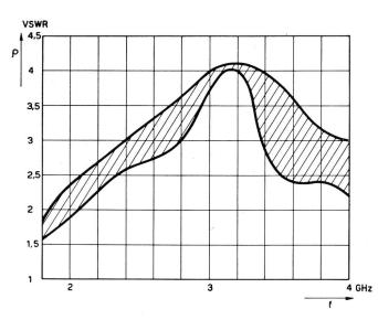
Fig. 33. 2 pos. Stecker Typ O mit neg.-neg. Verbindungsstück; nicht vorgesehen für dieses Frequenzgebiet
