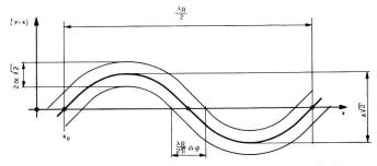
Fig. 3 Berechnung des Fehlers bei der Knotenverschiebungsmethode
