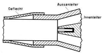
Fig. 19. Konstruktion der Übergangsstelle vom Kabel auf den Steckkontakt bei den Typen B, C und D
