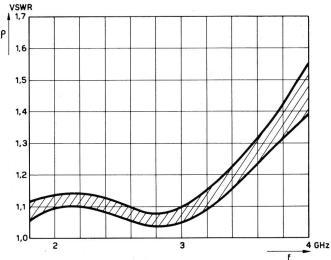
Fig. 29. Steckerpaar Typ K,  $Z_0=60\,\Omega$
