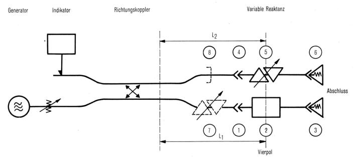
Fig. 8. Brückenmethode mit Richtungskoppler
