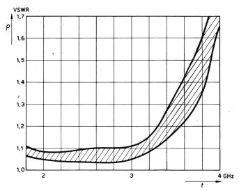
Fig. 30. Steckerpaar Typ L,  $Z_0=60~\Omega,$  vorgesehen für Frequenzen bis  $3~\mathrm{GHz}$
