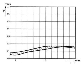
Fig. 18. Steckerpaar Typ H,  $Z_0=50\,\Omega,$  montiert nach spezieller Anleitung.
