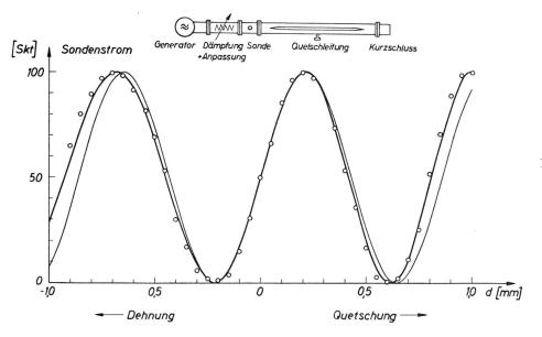
Fig. 4. Sendestrom in Abhängigkeit von der Quetschung bzw. Dehnung eines Hohlleiters (Breite a = 2,29 cm, Gesamtlänge 100 cm, Länge des Mittelstückes konstanter Breite
