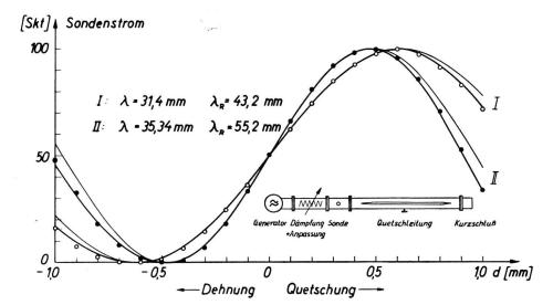
Fig. 3. Sondenstrom in Abhängigkeit von der Quetschung bzw. Dehnung eines Hohlleiters von der Breite a = 22,9 mm und der Länge 450 mm
