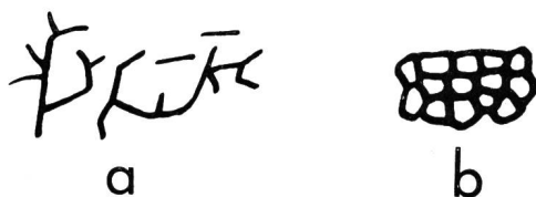
Fig. 11. Oberflächenstrukturen (schematisch) von Silber-Palladium-Kontakten, die dem Hochspannungsfunken ausgesetzt wurden
