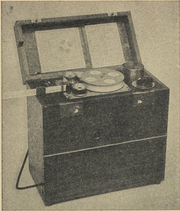
Apparat zur Kontrolle der Gesprächstaxierung
