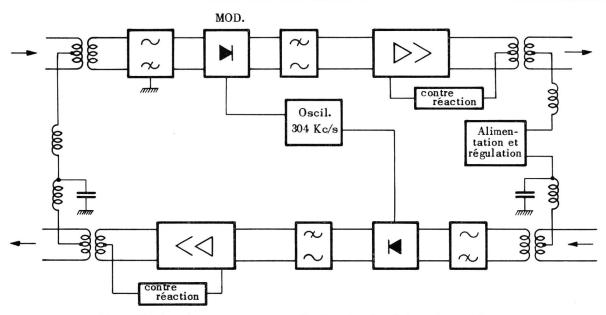
Fig. 5. Système à courants porteurs N<sub>1</sub>. Principe du répéteur intermédiaire
