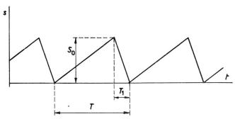
Fig. 7. Sägezahnschwingung
