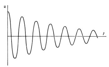
Fig. 6. Gedämpfte harmonische Schwingung
