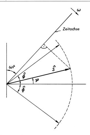
Fig. 15. Zeigerdiagramm für frequenz- und phasenmodulierte Schwingungen
