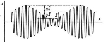
Fig. 11. Harmonisch amplitudenmodulierte Schwingung
