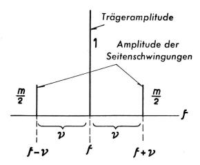
Fig. 12. Spektrum der harmonisch amplitudenmodulierten Schwingung
