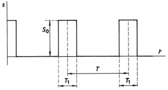
Fig. 8 Rechteckimpulsschwingung T = Periode  $T_1 = Impulsdauer$   $T_1 = T_1 = T_1$
