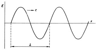
Fig. 5. Harmonische Welle c = Wellengeschwindigkeit  $\lambda = Wellenlänge$
