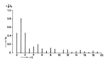
Fig. 9. Amplitudenspektrum der Rechteckimpulsschwingung nach Figur 8 mit  $\alpha=\frac{T_1}{T}=0.3$  bis 20 f<sub>1</sub>, wobei f<sub>1</sub> =  $\frac{1}{T}$
