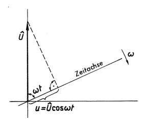
Fig. 4. Zeigerdarstellung für die Spannung
