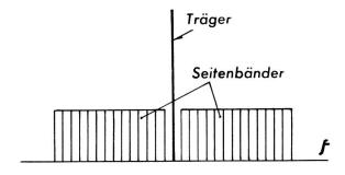
Fig. 14. Spektrum der mit einem Tongemisch amplitudenmodulierten Schwingung
