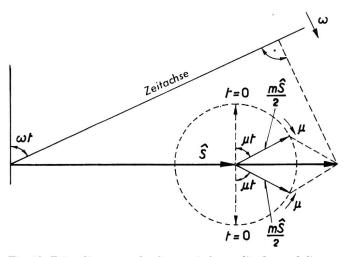
Fig. 13. Zeigerdiagramm der harmonisch amplitudenmodulierten Schwingung
