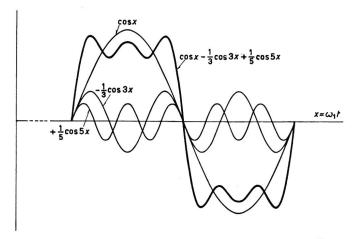
Fig. 10. Ausschau der Rechteckimpulsschwingung mit  $a=\frac{T_1}{T}=0,5$ , wenn von den *Fourier*-Komponenten nur diejenigen bis  $f_n=5\,f_1$  berücksichtigt werden
