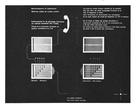
Fig. 7. Modèle «Transmission multiple par courants porteurs»
