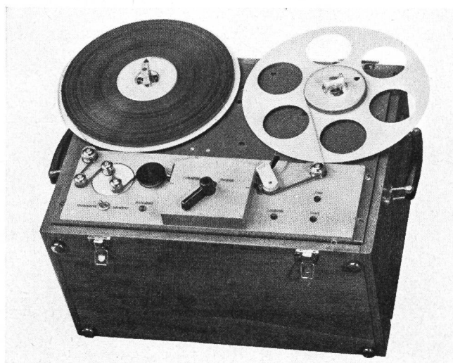
Fig. 5. Tragbares Magnetophon für Reportagen
