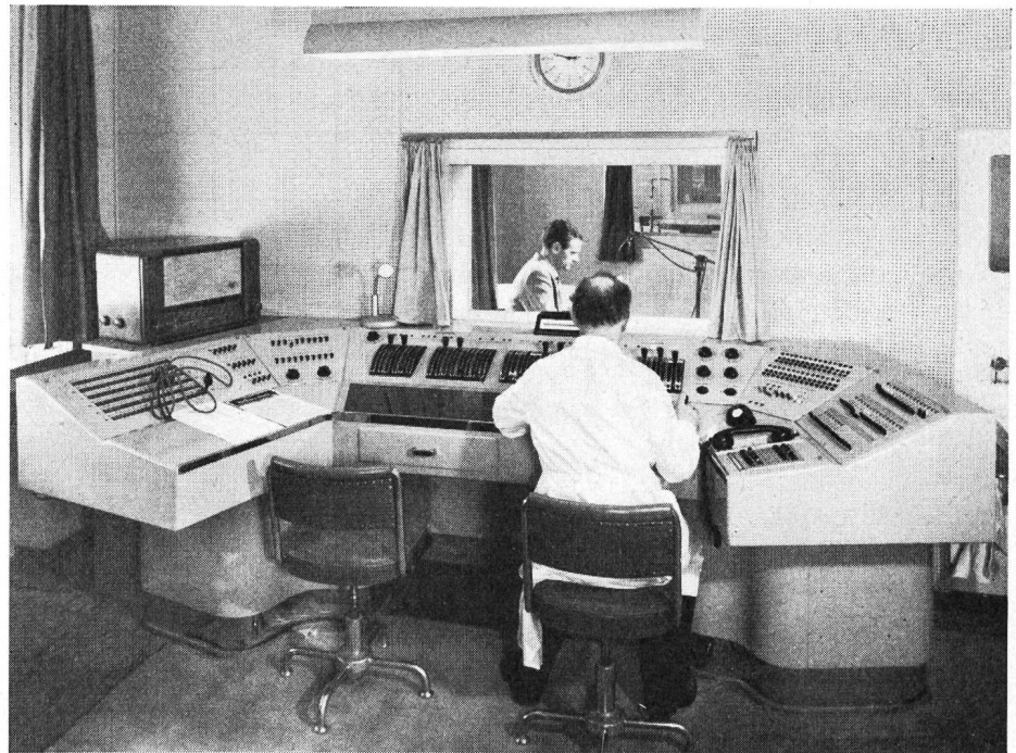
Fig. 1. Regiepult mit eingebauten Verstärkern, Schalt- und Kontrollorganen
