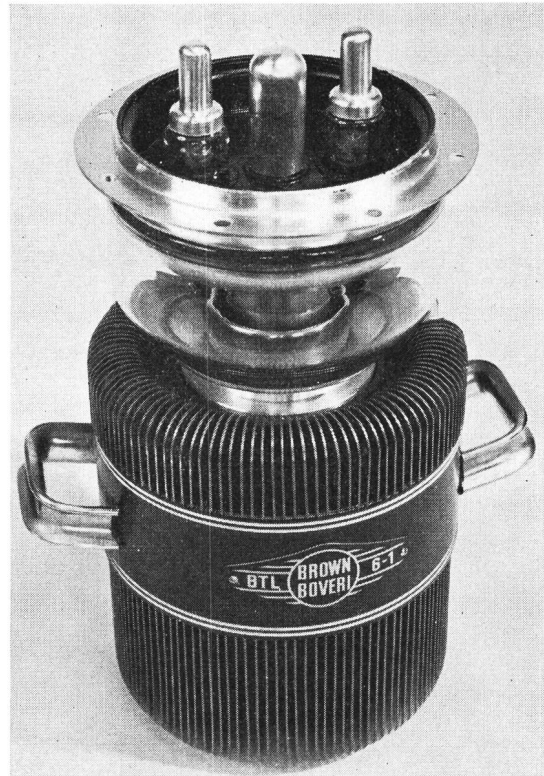
Fig. 11. Triode mit Luftkühlung (Brown-Boveri-Sendetriode BTL 6-1 mit thoriierter Wolframkathode; Anodenverlustleistung 6 kW)
