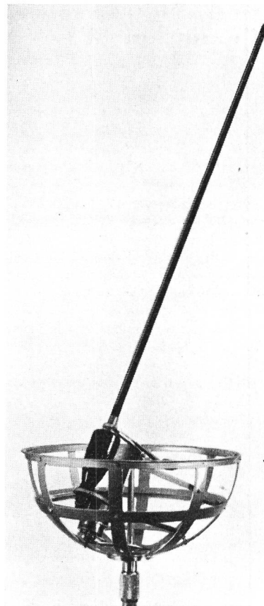
Fig. 2a und 2b. Schwenkbare Richtmikrophon zur automatischen Abtastung der Richtungsverteilung des Schalles
