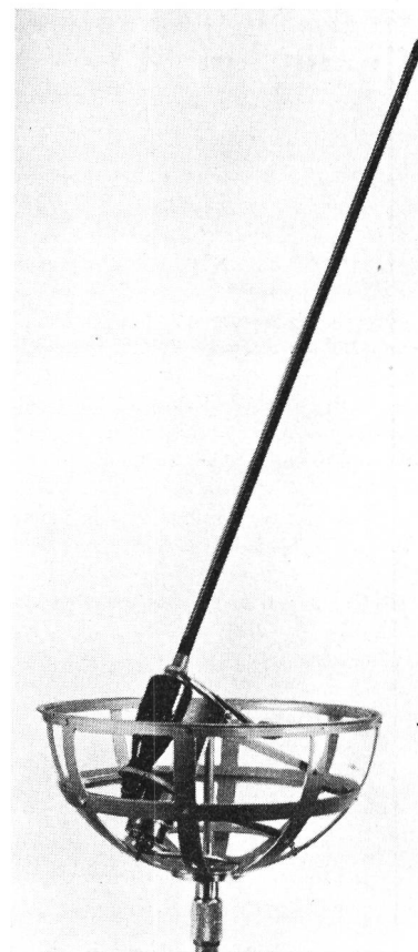
Fig. 2a und 2b. Schwenkbares Richtmikrophon zur automatischen Abtastung der Richtungsverteilung des Schalles
