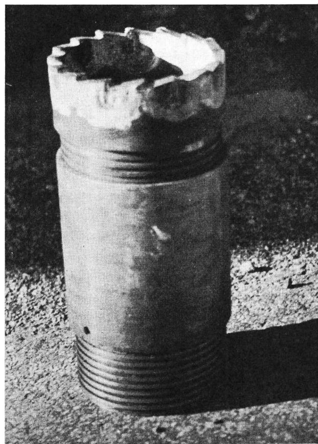
Fig. 12. Bohrkrone — Tarière en couronne
