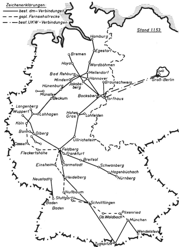
Fig. 27. Deutsches Richtstrahlnetz, Stand vom 1. I. 1953
