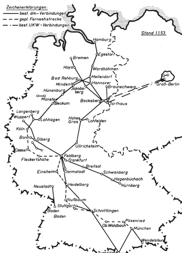
Fig. 27. Deutsches Richtstrahlnetz, Stand vom 1. I. 1953
