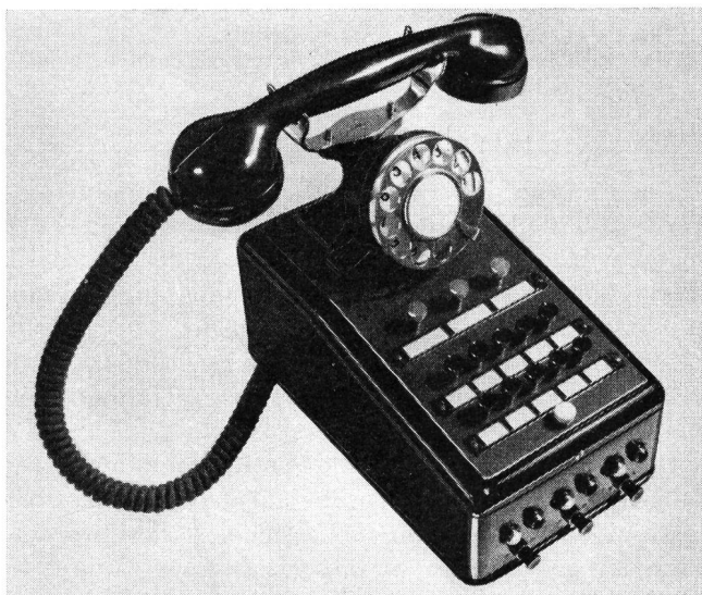
Fig. 1. Druckknopf-Linienwählerapparat Sélecteur de lignes à boutons
