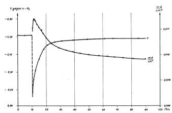
Fig. 5. Zeitlicher Verlauf von Strom und Potential im Korrosionselement Pb/Pt (Pb-Elektrode B, und Pt-Elektrode P<sub>1</sub> in 0,08-n KCl, ruhend, lufthaltig, ca. 20° C,  $R_a$  1  $\varOmega$ )
