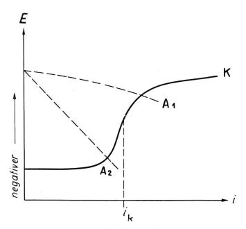
Fig. 2. Kathodische Polarisationskurve K bei Sauerstoff-Diffusionskontrolle, mit kritischer Stromdichte  $i_{\rm K}$ . Anodische Polarisationskurven  ${\bf A}_1$  und  ${\bf A}_2$
