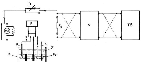
Fig. 3. Die elektrische Schaltung zum Korrosionselement. Z Zelle, Pb und Pt Bleibzw. Platinelektrode, K Kalomelelektroden, P Potentialmessgerät (Titriskop), mA Unipivot-Strommessinstrument,  $R_s$  auswechselbarer Shunt (0 bzw. 0,1 bzw. 0,5 bzw. 1,0 bzw. 10  $\Omega$ ), V Gleichstromverstärker, TS Tintenschreiber,  $R_z$  zusätzlicher Widerstand
