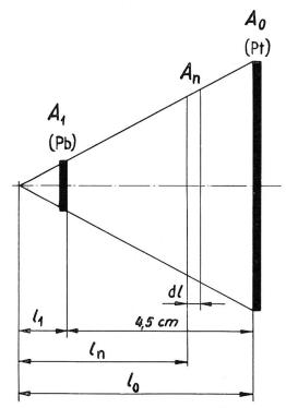
Fig. 7. Zur Berechnung des Elektrolytwiderstandes zwischen der Platinelektrode Pt mit der freien Oberfläche  $A_0$  (= 14 cm²) und einer kleineren Bleielektrode Pb mit der freien Oberfläche  $A_1$  im Abstand von 4,5 cm
