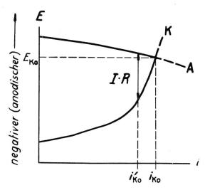
Fig. 1. A anodische und K kathodische Polarisationskurve eines Korrosionselementes.  $i_{\rm Ko}$  und  $i'_{\rm Ko}$  sind «Korrosions-Stromdichten»,  $E_{\rm Ko}$  ist das «Korrosions-Potential»
