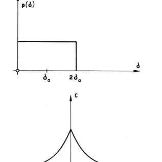
Fig. 35 a+b. a) Verteilungsfunktion der Impulslängen und b) dazugehörige Autokorrelationsfunktion einer Impulsfolge (Folge d)
