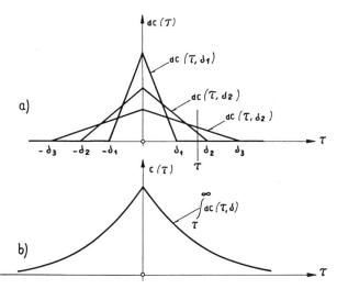
Fig. 34. Bildung der Autokorrelationsfunktion für eine Impulsfolge mit verschiedenen Impulslängen
