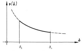
Fig. 36. Verteilungsfunktion der Impulslängen (schematisch) für die Impulsfolgen e und f
