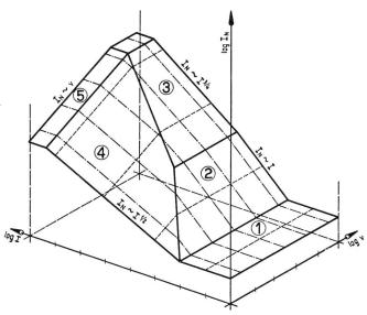
Fig. 30. Schematische Darstellung der Abhängigkeit des Rauschstromes von Gleitgeschwindigkeit und Belastungsstrom
