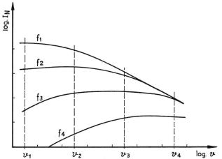
Fig. 16. Variation des Rauschspektrums mit der Gleitgeschwindigkeit unter gleichen Voraussetzungen wie Fig. 15, aber für ein praktisch vorkommendes Spektrum
