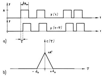
Fig. 33. Bildung der Autokorrelationsfunktion einer Folge identischer Impulse
