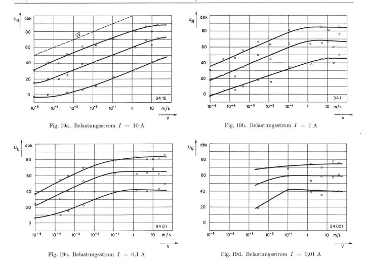
Fig. 19a...d. Gemessene Abhängigkeit der Rauschspannung von der Gleitgeschwindigkeit für Messfrequenzen 2, 64, 2000 kHz. Kohle Nr. 1, Kontaktkraft = 10 N
