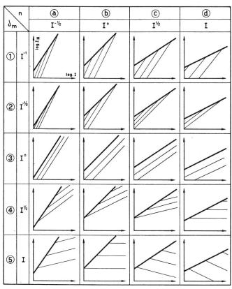
Fig. 20. Abhängigkeit des Rauschstromes vom Belastungsstrom. Schematisierter Verlauf des Zusammenhanges für verschiedene Messfrequenzen, wenn sich die mittlere Impulsdauer  $\delta_m$  und die mittlere Impulszahl n in der angegebenen Weise mit dem Belastungsstrom ändern
