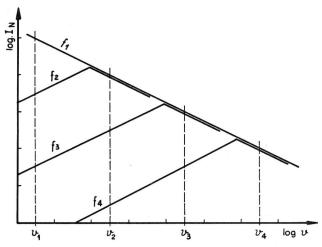
Fig. 15. Variation des Rauschspektrums mit der Gleitgeschwindigkeit unter der Annahme, dass der Elementarimpuls seine Dauer im Mittel umgekehrt proportional zur Gleitgeschwindigkeit ändert und für einen schematischen Verlauf des Spektrums («Korntheorie»)
