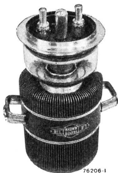
Fig. 2. Kurzwellensendetriode mit thorierter Kathode für eine Verlustleistung von 6 kW
