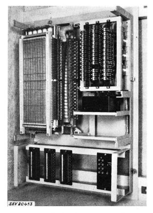
Fig. 8. Leitungsdurchschalter der Firma Gfeller-AG.
