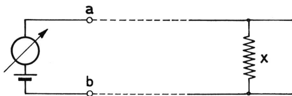
Fig. 1. Messung einer offenen Einzelleitung mit dem Isolationswiderstand x Mesure d'un circuit ouvert avec la résistance d'isolement x
