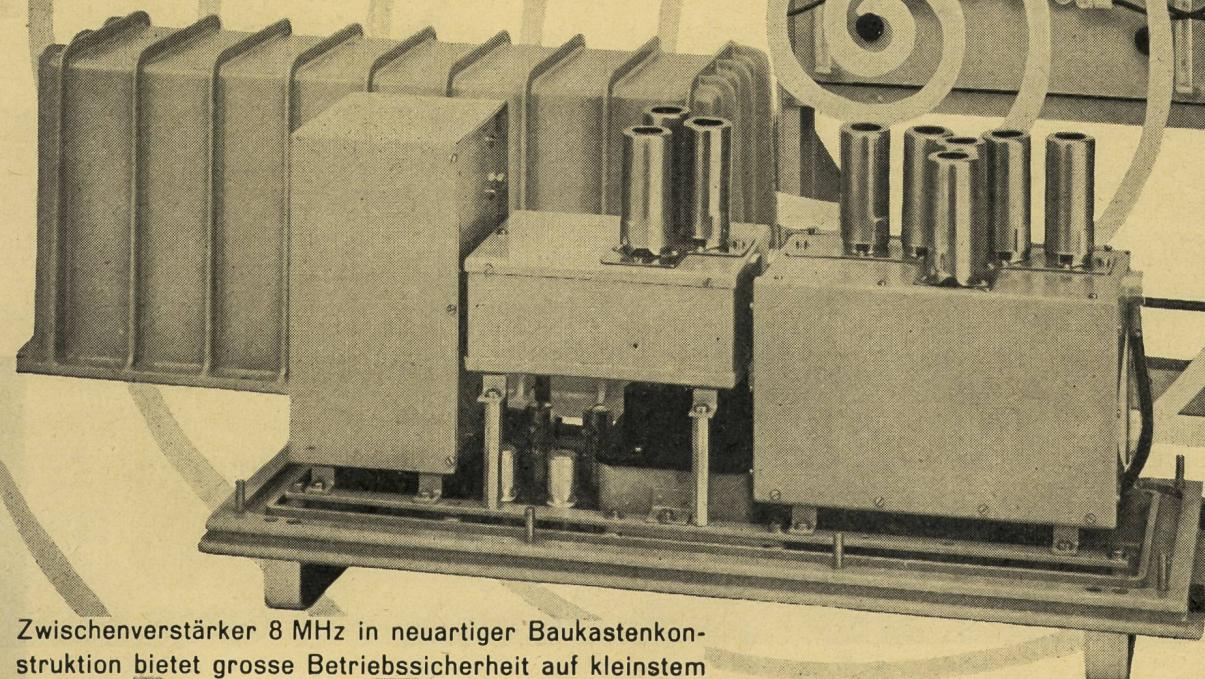
Zwischenverstärker 8 MHz in neuartiger Baukastenkon-
