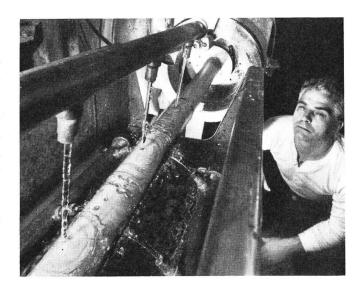
Fig. 3. Fabrikation eines neuen Kabeltyps. Abkühlen des noch heissen Plasticmantels durch Wasser Fabrication d'un nouveau type de câble. Refroidissement par eau de la gaine de plastique encore chaude
