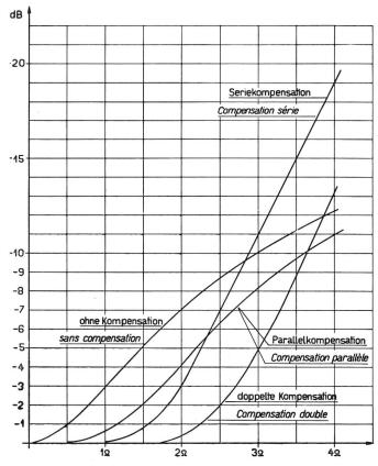
Fig. 2. Verlauf der Bezugsverstärkung Amplification relative
