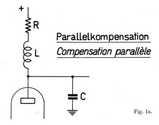
Le paramètre Q doit être choisi de façon que la première dérivée de l'amplification pour des fréquences positives soit toujours plus petite ou égale à zéro. La plus grande valeur de Q sera dans ces conditions:
