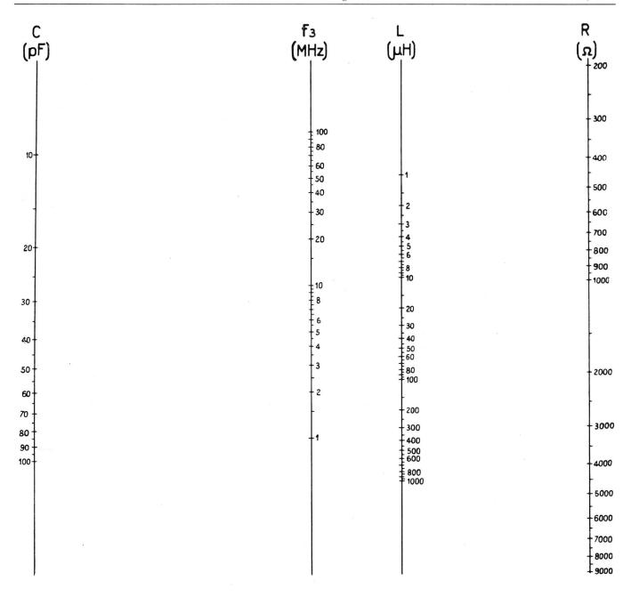
Q = 0,6436 Nomogramm für Parallel-Kompensation — Nomogramme pour compensation parallèle
