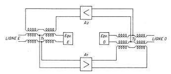
$Fig.~5.~Répéteur~à~2~fils\\ T_1/T_2~=~transformateurs~différentiels\\ A_1/A_2~=~éléments~amplificateurs~proprement~dits$
