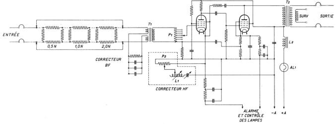
Fig. 14. Répéteur à 4 fils, type N.E.P.
