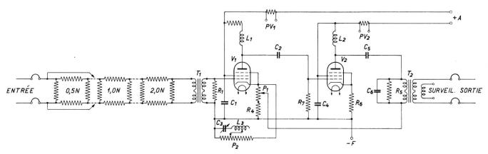
Fig. 12. Répéteur à 4 fils à contre-réaction
