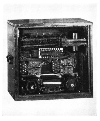
Fig. 6b. Répéteur à 2 fils «Western», vue arrière
