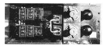
Fig. 10a. Vue avant d'un répéteur à deux fils
