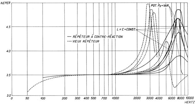
Fig. 13. Gain des répéteurs à 4 fils
