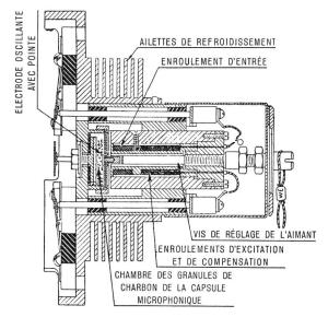
Fig. 1. Amplificateur mécanique
