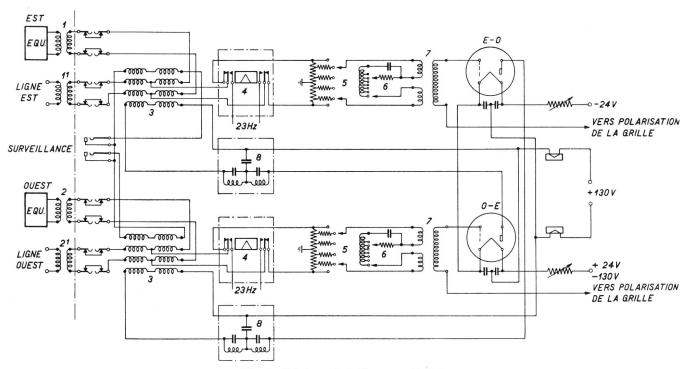
Fig. 8. Répéteur à 2 fils, type 22-A-1
