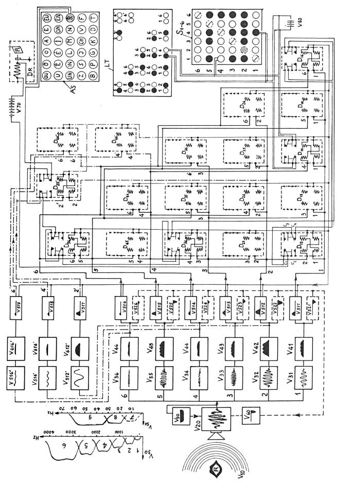
Fig. 3. Typo-sonographe phonétique ou phonétographe (principe)
