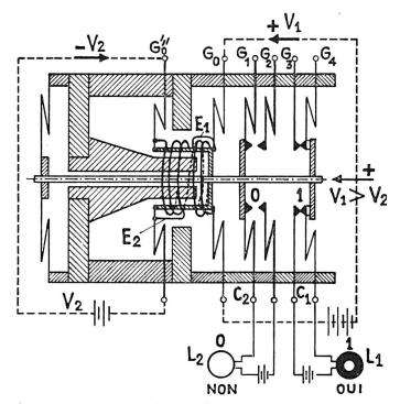
Fig. 6. Relais électrodynamique (coupe)
