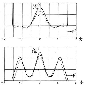
Fig. 2. Relatives Amplitudenquadrat der elektrischen Feldstärke in einer kreisförmigen Öffnung längs des zu  $\mathfrak{G}^e$  und  $\mathfrak{H}^e$  parallelen Durchmessers strenge Rechnung  $d=3,18~\lambda$  (Andrejewski) gemessen  $d=3~\lambda$  (Andrews)
