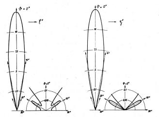
Fig. 6. Relative Intensität der gebeugten Welle in Abhängigkeit von der Strahlrichtung θ für die leitende Kreisscheibe vom Durchmesser d = 3,18 λ in der &- und &-Ebene. Fernfeld streng gerechnet (Andrejewski)
