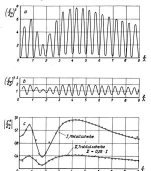
Fig. 7. Gemessenes relatives Amplitudenquadrat der elektrischen Feldstärke auf der Mittelnormalen vor a) einer kreisförmigen Metallscheibe, Durchmesser d = 4  $\upbeta$  b) einer Trolitulscheibe gleicher Grösse, Reflexionsfaktor r = 0,28
