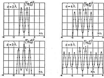
Fig. 1. Relatives Amplitudenquadrat der elektrischen Feldstärke in der kreisförmigen Öffnung (Durchmesser d =  $2\lambda$ ,  $3\lambda$ ,  $4\lambda$ ,  $8\lambda$ ) längs des zu  $\mathfrak{H}^e$  parallelen Durchmessers (Andrews)
