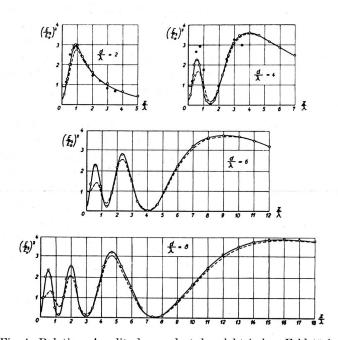
Fig. 4. Relatives Amplitudenquadrat der elektrischen Feldstärke auf der Mittelnormalen hinter einer kreisförmigen Öffnung vom Durchmesser d =  $2\lambda$ ,  $4\lambda$ ,  $6\lambda$ ,  $8\lambda$  elektrische Dipole magnetische Dipole
