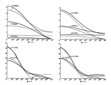
Fig. 14. Relative Schalldruckamplitude der Beugungswelle im Fernfeld in Abhängigkeit von der Strahlrichtung  $\vartheta$  für die schallharte Kreisscheibe (linkes Bild) und die kreisförmige Öffnung im schallharten Schirm (rechtes Bild) vom Durchmesser d = 0,32  $\lambda$ , 0,64  $\lambda$ , 0,96  $\lambda$ , 1,27  $\lambda$ , 1,59  $\lambda$
