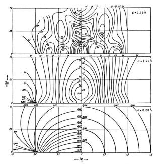
Fig. 13. Kurven gleichen Schalldrucks der Beugungswelle in der Umgebung einer schallharten Kreisscheibe vom Durchmesser d = 0,08 \(\lambda\), 1,27 \(\lambda\), 3,18 \(\lambda\). Linke Hälfte: Exaktes Feld (Meixner und Fritze). Rechte Hälfte: Kirchhoffsche Näherung, Kugelstrahler (Stenzel)
