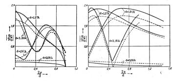
Fig. 12. Relative Schalldruckamplitude der Beugungswelle an der Oberfläche (linkes Bild) und auf der Mittelnormalen (rechtes Bild) einer schallharten Kreisscheibe vom Durchmesser d = 0,08 λ, 1,27 λ, 1,91 λ, 3,18 λ
