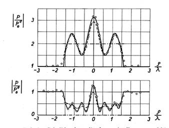
Fig. 11. Relative Schalldruckamplitude unmittelbar vor und hinter einer schallharten Kreisscheibe vom Durchmesser  $\frac{d=3{,}18\;\lambda}{------} \quad \text{exakte Rechnung (Meixner und Fritze)}$  Kugelstrahler
