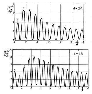
Fig. 5. Relatives Amplitudenquadrat der elektrischen Feldstärke auf der Mittelnormalen vor kreisförmigen Metallscheiben vom Durchmesser d $=2~\lambda,~3~\lambda$
