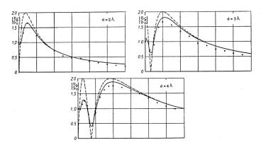
Fig. 10. Relative Schalldruckamplitude auf der Mittelnormalen hinter einer kreisförmigen Öffnung vom Durchmesser  $\frac{d=2}{2} \lambda$ ,  $3 \lambda$ ,  $4 \lambda$ , Dipole, ---- Kugelstrahler, • Messpunkte
