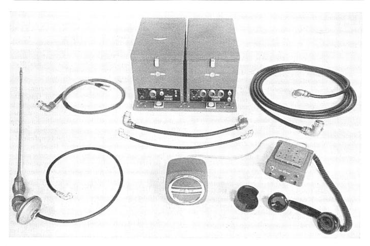
Fig. 10. Gesamtansicht einer mobilen Teilnehmerstation ohne Batterie (Fabrikat Brown, Boveri & Cie., Baden)
