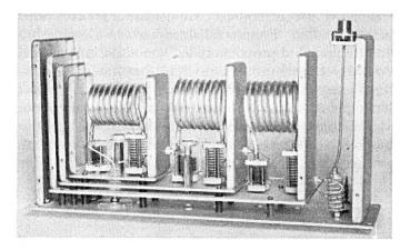
Fig. 9. Antennen-Frequenzweiche zur gleichzeitigen Ausnützung einer Antenne für beide Übertragungsrichtungen im selben Frequenzband (Fabrikat Autophon AG., Solothurn)
