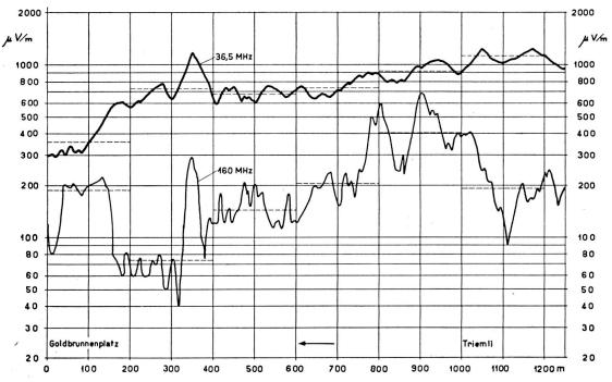
Fig. 4. Feldstärkeregistrierung mit 35,6/160 MHz in Zürich (Triemli), Strasse annähernd quer zur Ausbreitungsrichtung, Normalregistrierung
