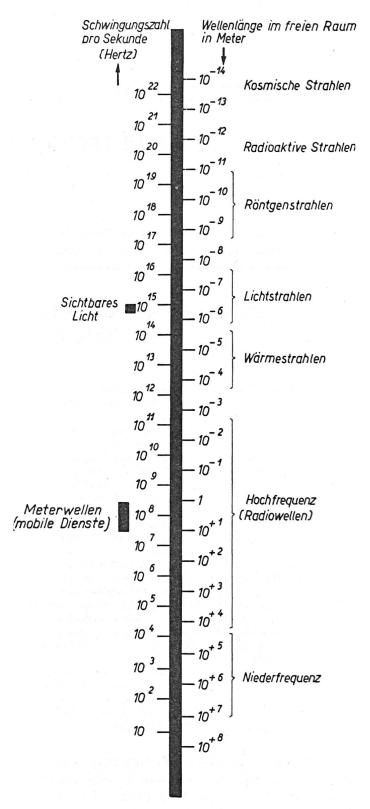
Fig. 1. Spektrum der elektromagnetischen Wellen
