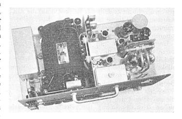
Fig. 7. PM-Sender für mobile Telephondienste im 160-MHz-Frequenzband, Antennenleistung 25 W (Fabrikat Autophon AG., Solothurn)
