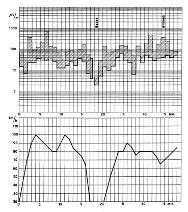
Fig. 19. Störspannungsregistrierung 200 MHz im fahrenden Zug zwischen Zürich und Olten; Messwagen mit Antenne direkt hinter der Lokomotive. Bandbreite 200 kHz, Bewertung mit einer Lade-/Entlade-
