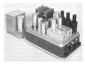
Fig. 21a. Auto-Anrufempfänger mit 3 tonselektiven Relais und spezieller Anrufverschlüsselung (Fabrikat Hasler AG., Bern)
