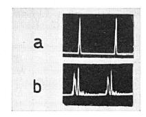
Fig. 2c. Empfangsbeispiel aus einem indirekt bestrahlten Alpental, Sender mit Impulsen von je 1/3000 Sek. Abstand, entsprechend einer Weglänge von 100 km moduliert a Sendersignal
