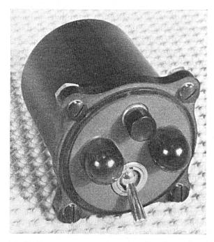
Fig. 21b. Bedienungsgerät zum Auto-Anrufempfänger der Fig. 21a
