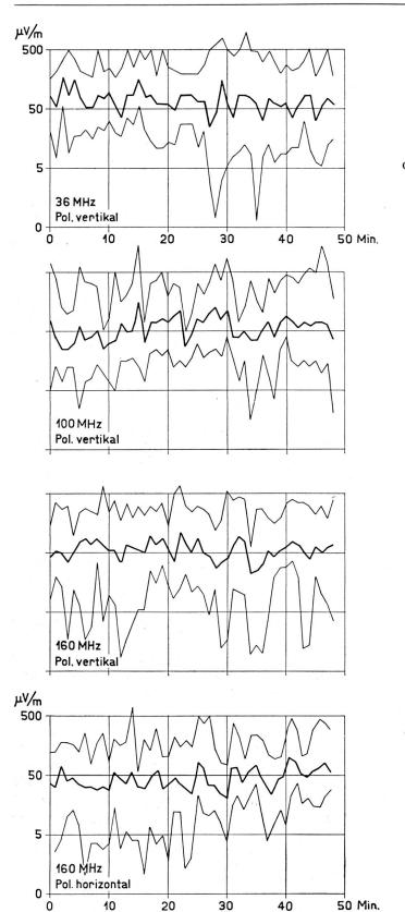
Fig. 13. Zeitlicher Verlauf minütlicher Mittelwerte, Maxima und Minima der Störfeldstärke von Autozündstörungen im dichten Stadtverkehr in Bern, bezogen auf eine Bandbreite von 100 kHz, wie in Fig. 12.
