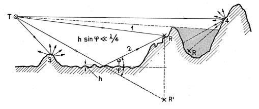
Fig. 2b. Qualitatives Bild der Wellenreflexion
